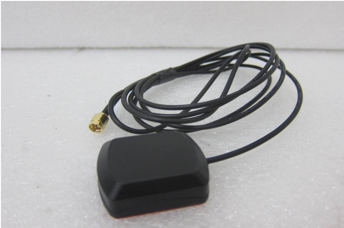
EUT 15 GPS Antenna
