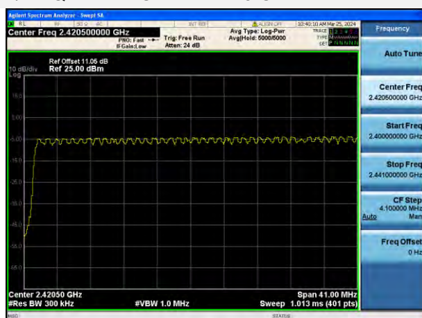
\pi/4 -DQPSK 2.4 GHz ~ 2.4415 GHz
