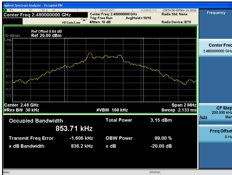
Test Mode:  $\pi/4$ DQPSK
