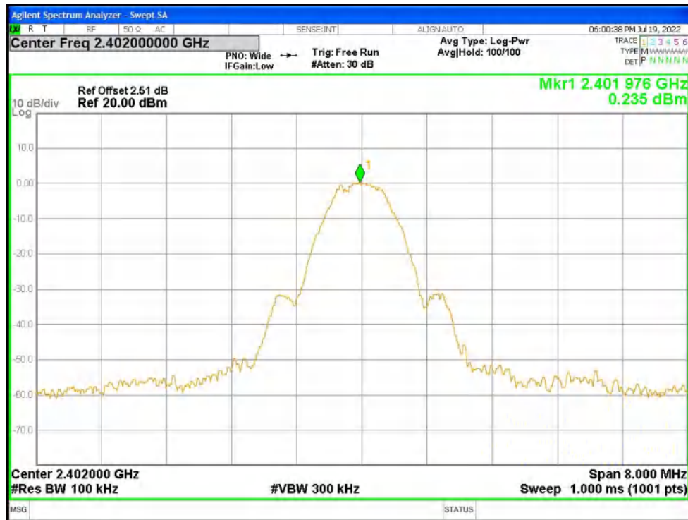
Band Edge NVNT BLE 2402MHz Ant1 Emission
