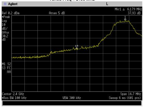
Band Edge 2483.5 MHz Tuned Freq = 2474 MHz
