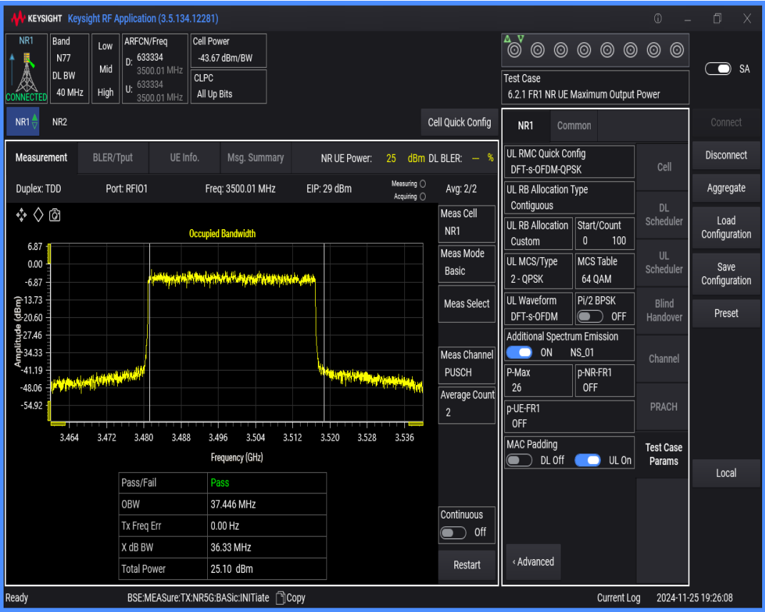
n77(3450-3550) SCS=30kHz DFT_QPSK BW=20MHz Channel=633334 RB=50@0
