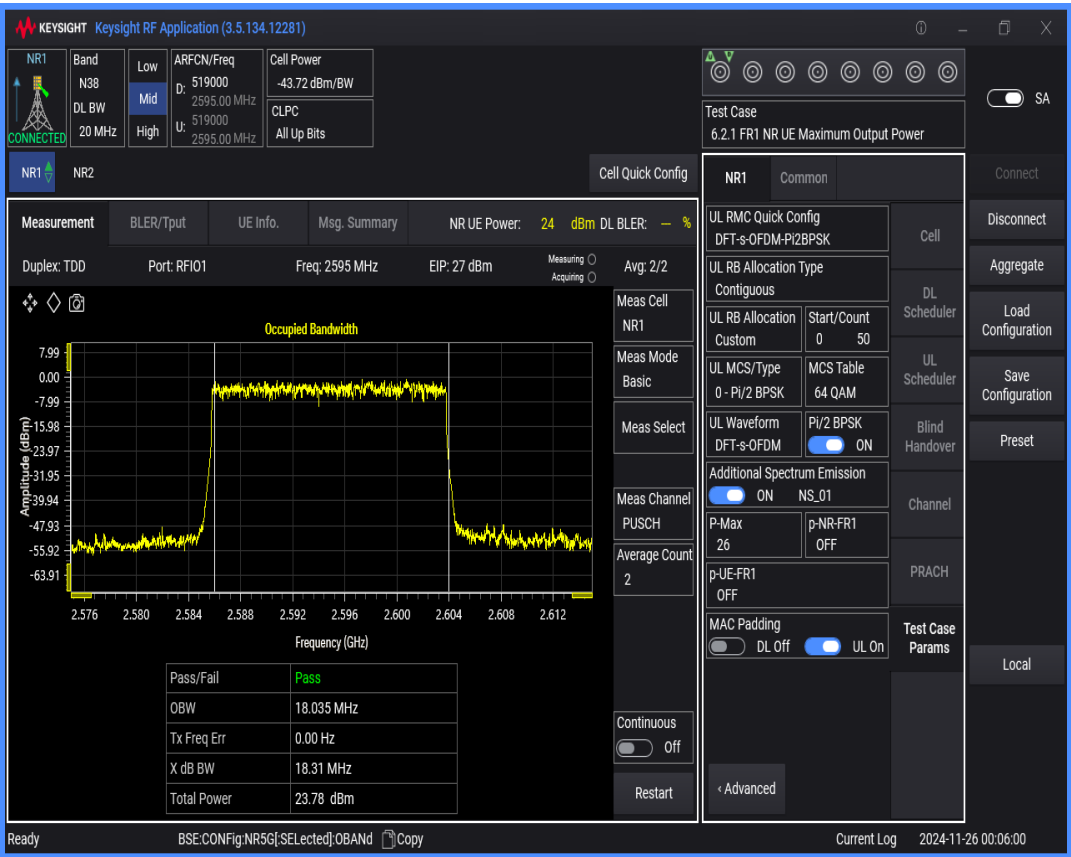
n38 SCS=30kHz DFT_QAM16 BW=20MHz Channel=519000 RB=50@0
