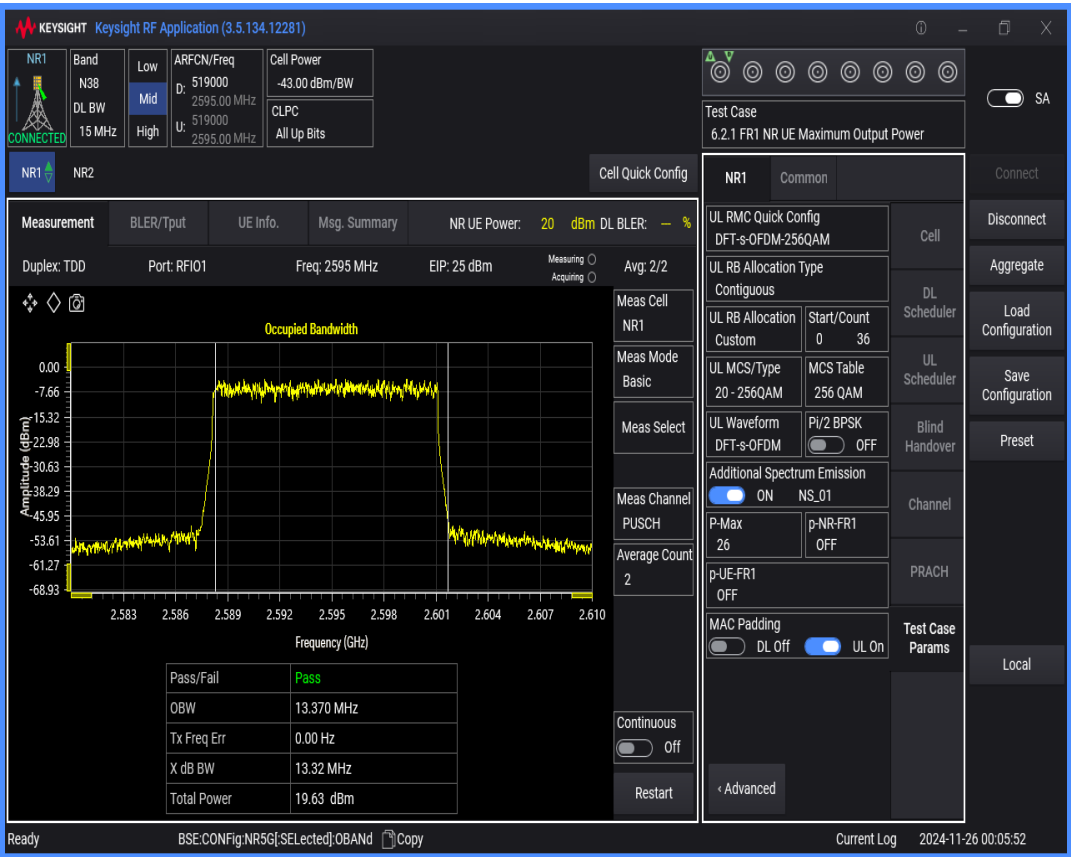
n38 SCS=30kHz DFT_QAM64 BW=20MHz Channel=519000 RB=50@0
