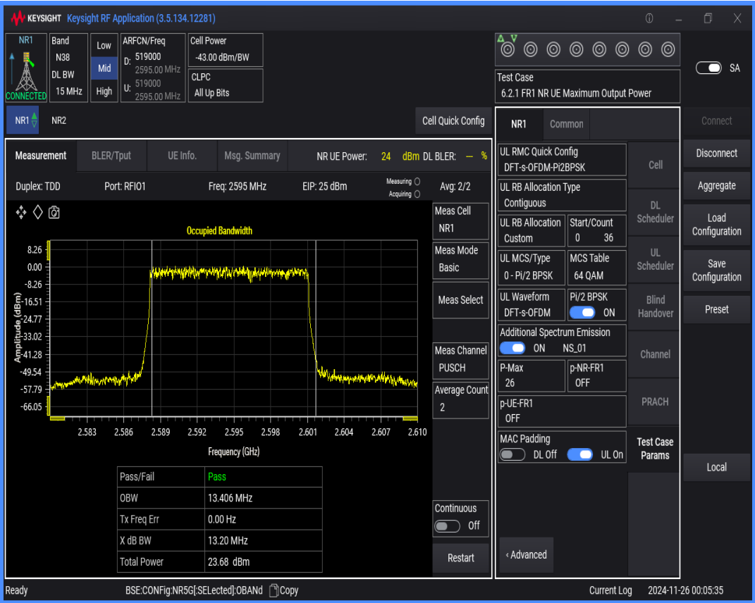
n38 SCS=30kHz DFT_BPSK BW=20MHz Channel=519000 RB=50@0
