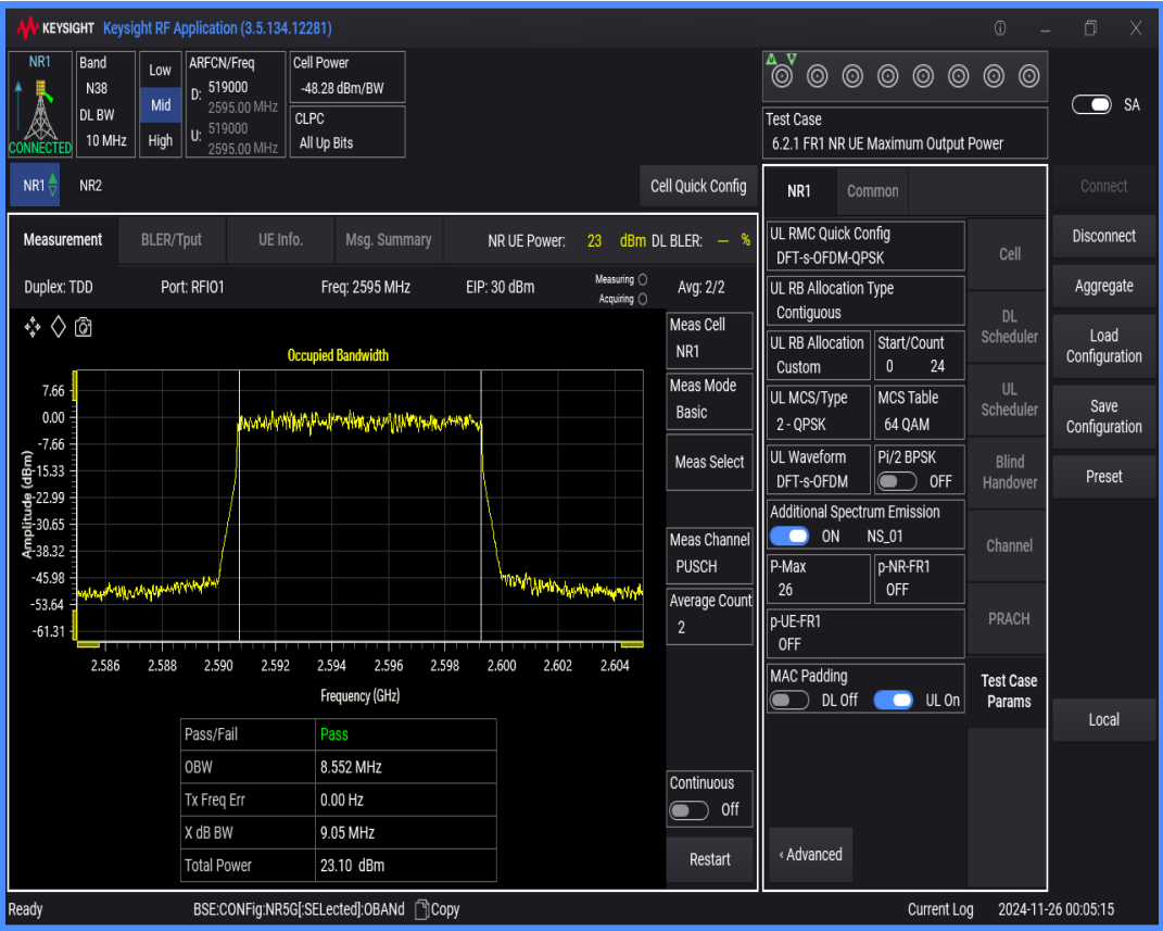
n38 SCS=30kHz DFT_QPSK BW=15MHz Channel=519000 RB=36@0
