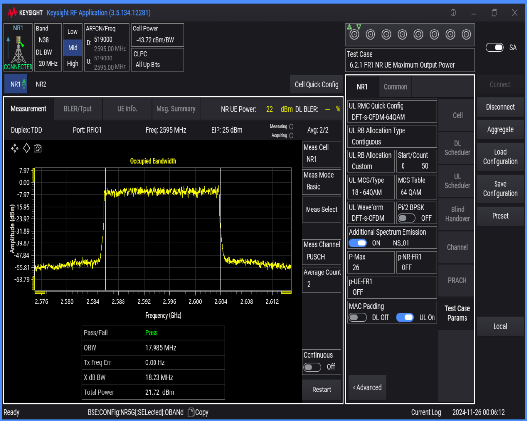
n38 SCS=30kHz DFT_QPSK BW=10MHz Channel=519000 RB=24@0
