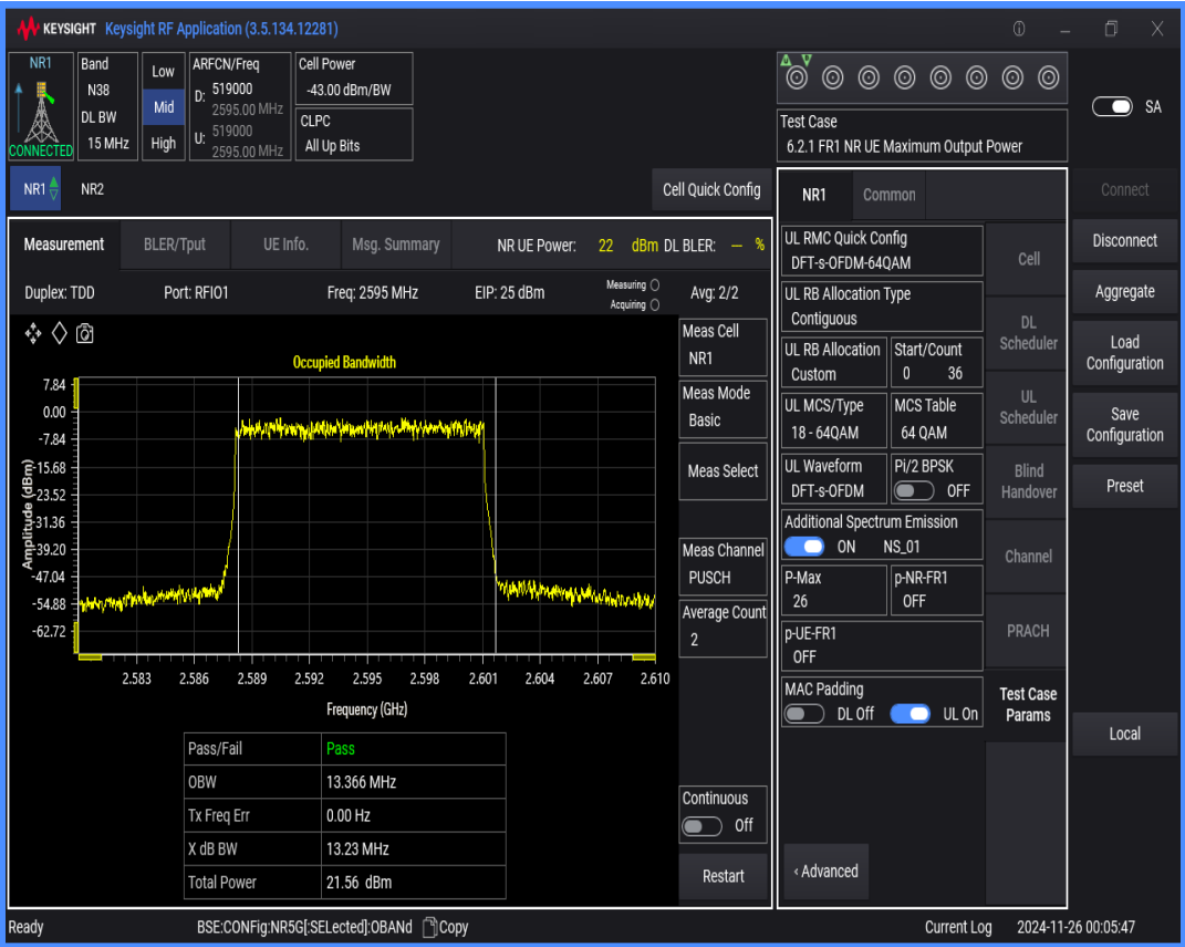
n38 SCS=30kHz DFT_QAM256 BW=20MHz Channel=519000 RB=50@0
