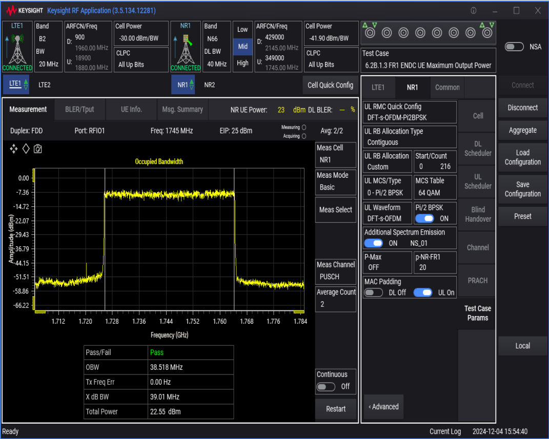
n66 SCS=15kHz DFT_BPSK BW=10MHz Channel=349000 RB=50@0
