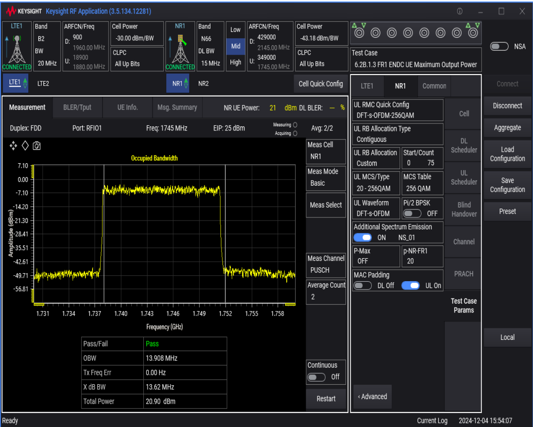
n66 SCS=15kHz DFT_QAM256 BW=10MHz Channel=349000 RB=50@0
