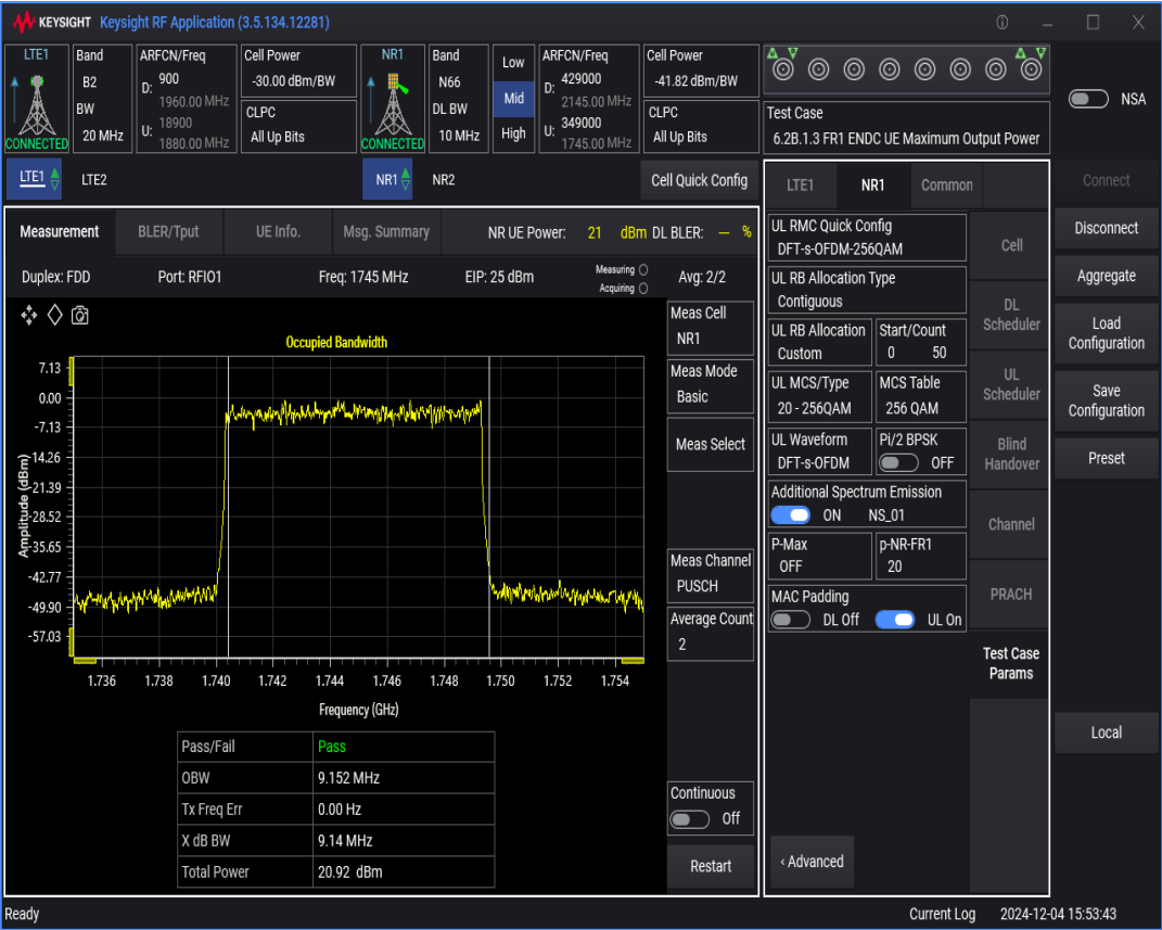
n66 SCS=15kHz DFT_QAM16 BW=10MHz Channel=349000 RB=50@0
