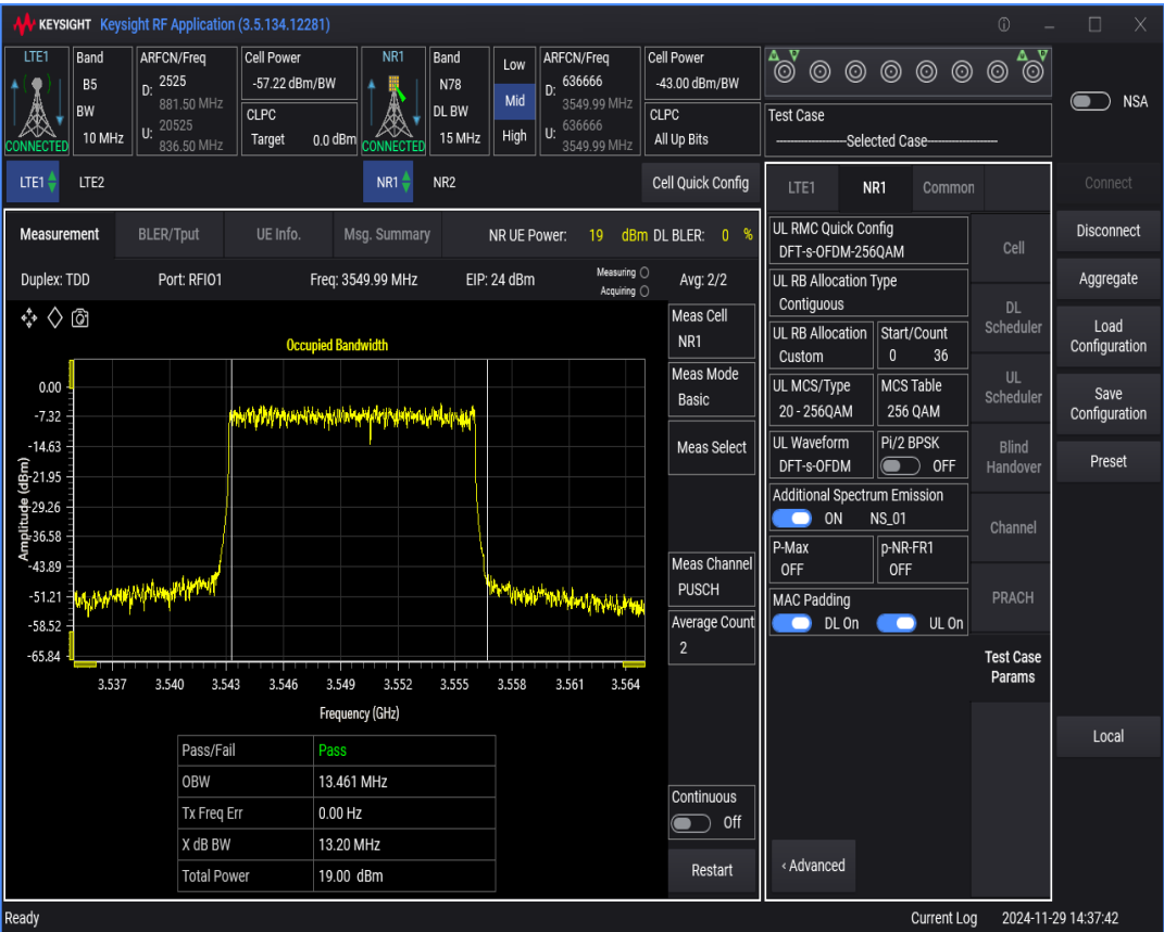
n78 SCS=30kHz DFT_QAM256 BW=20MHz Channel=636666 RB=50@0
