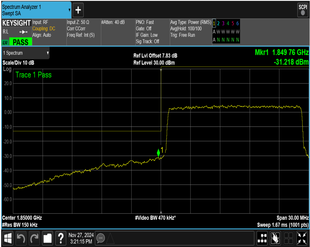
Band2 QPSK BW=20MHz Channel=19100 RB Size=100 Position=#0
