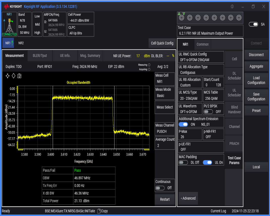
n78(3550-3700) SCS=30kHz DFT_QAM256 BW=20MHz Channel=641666 RB=50@0
