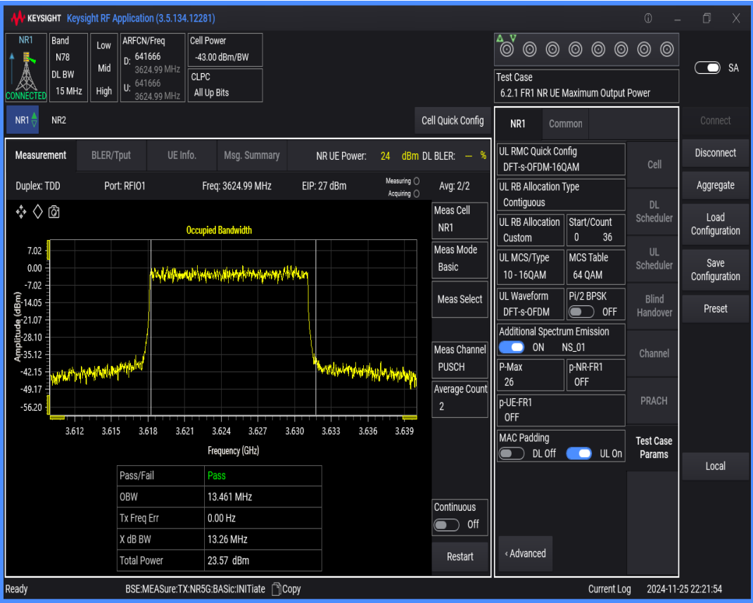
n78(3550-3700) SCS=30kHz DFT_QAM16 BW=20MHz Channel=641666 RB=50@0
