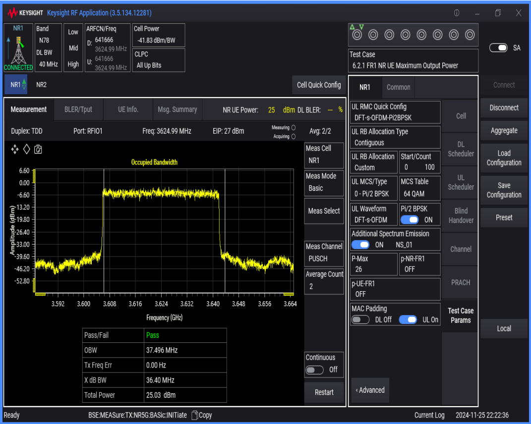
n78(3550-3700) SCS=30kHz DFT_BPSK BW=20MHz Channel=641666 RB=50@0
