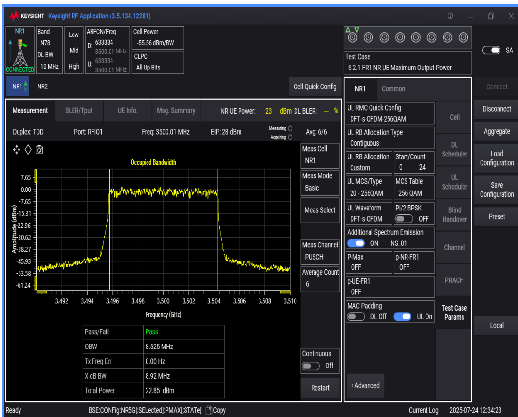
n78(3450-3550) SCS=30kHz DFT_QAM256 BW=20MHz Channel=633334 RB=50@0
