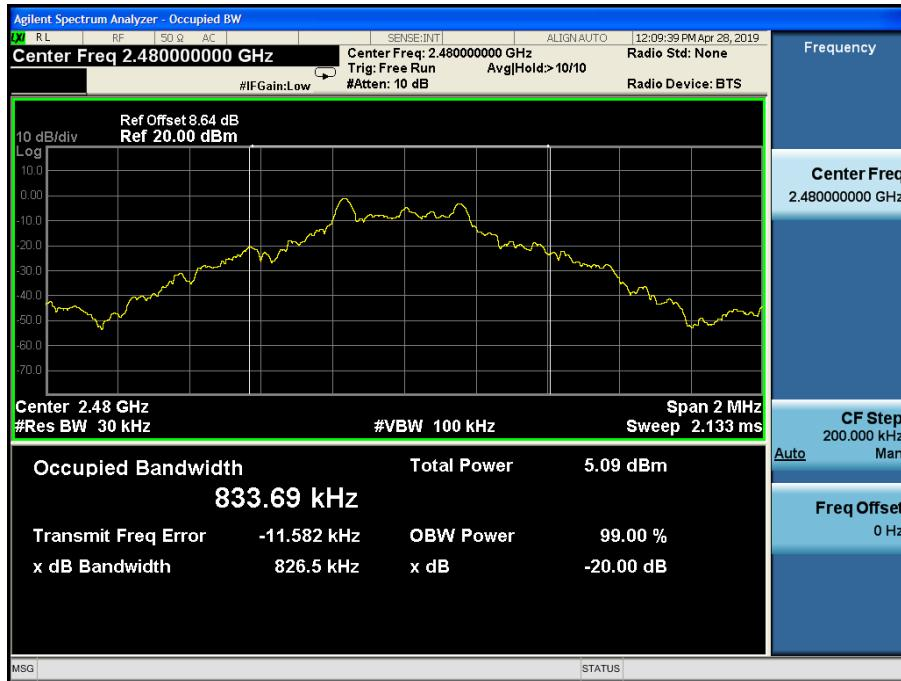
Test Mode:  $\pi$  /4DQPSK
