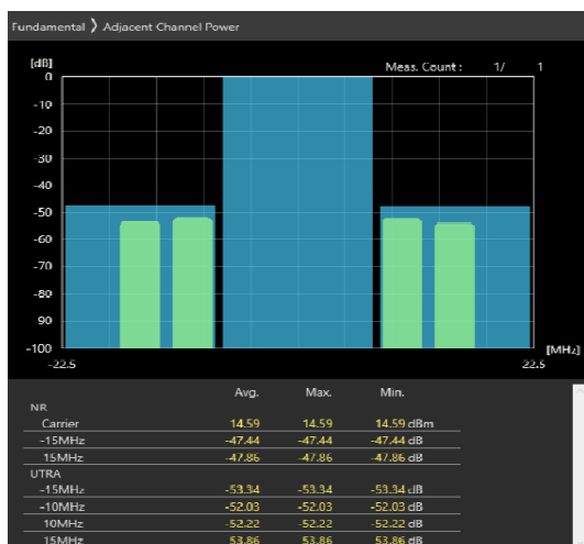
15MHz_30kHz_3692.5MHz-OFDM QPSK_RB18@9 -47.44,-47.86dB
