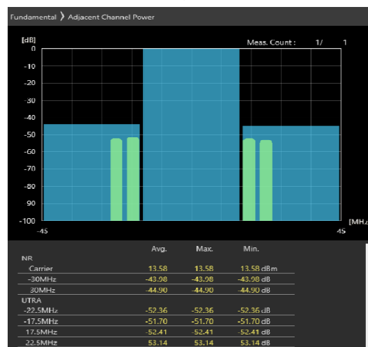
30MHz_30kHz_3685MHz-OFDM QPSK_RB75@0 -43.98,-44.9dB
