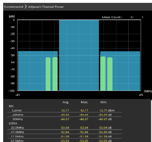
30MHz_30kHz_3685MHz-OFDM QPSK_RB75@0 -43.98,-44.9dB
