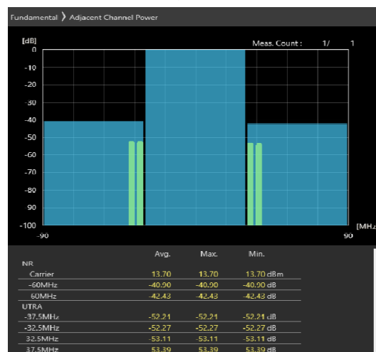
60MHz_30kHz_3670MHz-OFDM QPSK_RB162@0 -40.9,-42.43dB
