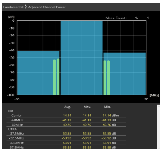
60MHz_30kHz_3580MHz-OFDM QPSK_RB162@0 -41.17,-42.54dB
