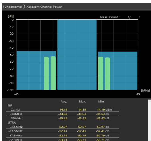
30MHz_30kHz_3685MHz-OFDM QPSK_RB36@18 -44.93,-46.06dB
