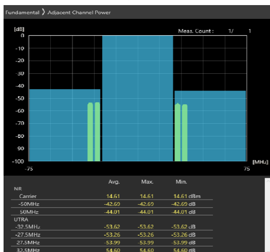
50MHz_30kHz_3675MHz-OFDM QPSK_RB64@32 -42.69,-44.01dB
