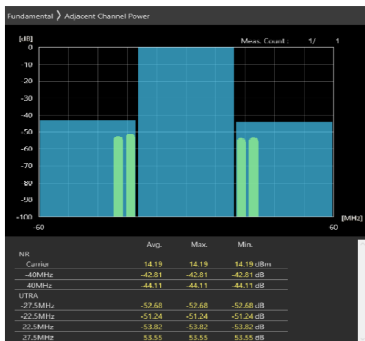
40MHz_30kHz_3570MHz-OFDM QPSK_RB100@0 -43.11,-44.11dB
