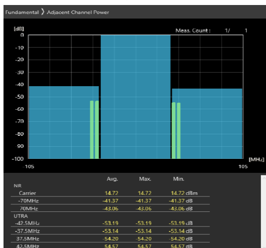
70MHz_30kHz_3665MHz-OFDM QPSK_RB90@45 -41.37,-43.06dB
