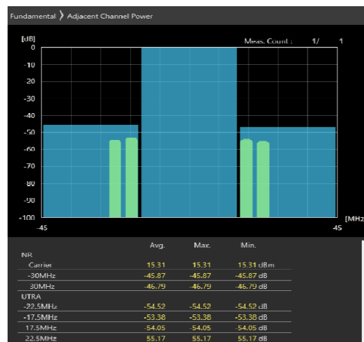
30MHz_30kHz_3685MHz-OFDM QPSK_RB1@77 -44.44,-44.67dB
