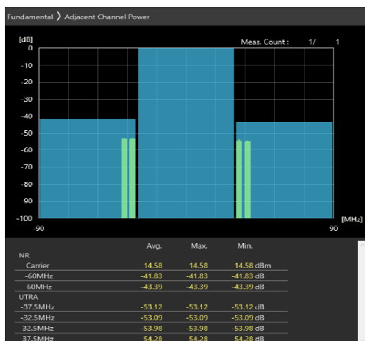
60MHz_30kHz_3670MHz-OFDM QPSK_RB81@40 -41.83,-43.39dB
