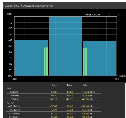
70MHz_30kHz_3665MHz-OFDM QPSK_RB180@0 -40.42,-42.16dB
