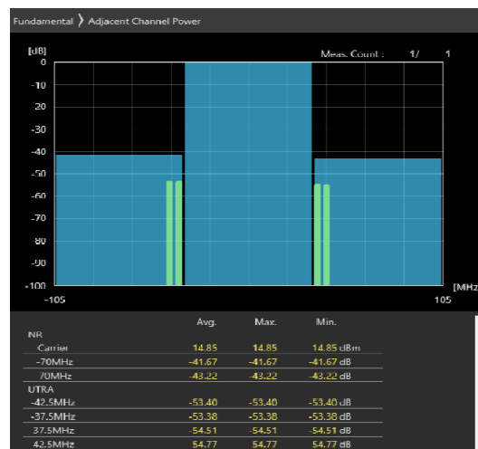
70MHz_30kHz_3665MHz-OFDM QPSK_RB1@188 -40.36,-41.54dB
