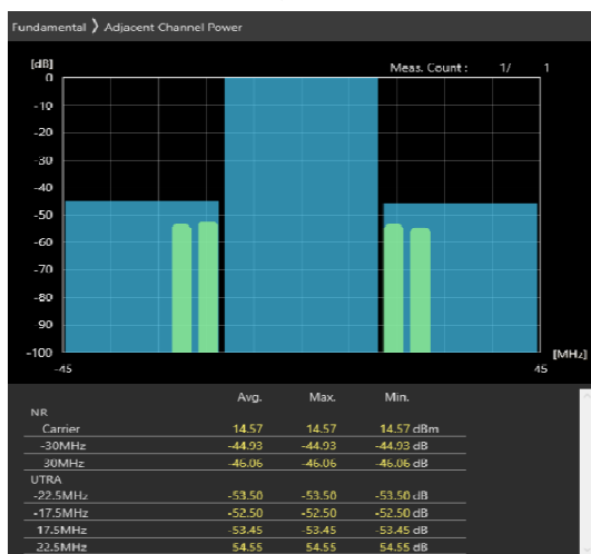
30MHz_30kHz_3685MHz-OFDM QPSK_RB36@18 -44.93,-46.06dB
