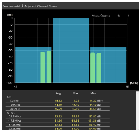
30MHz_30kHz_3565MHz-OFDM QPSK_RB75@0 -44.63,-45.42dB
