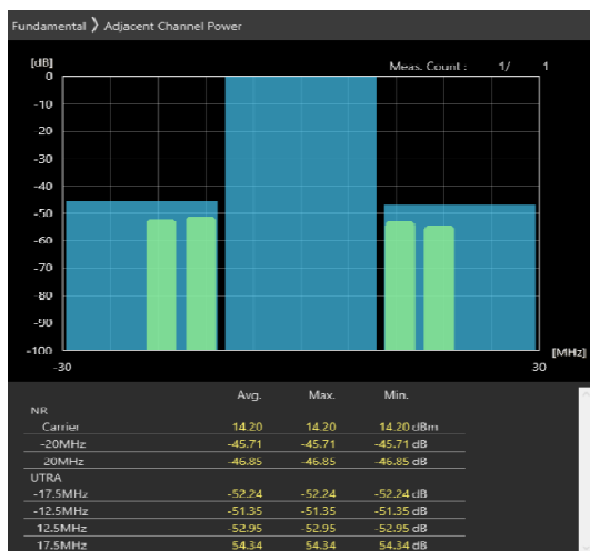
20MHz_30kHz_3560MHz-OFDM QPSK_RB50@0 -46.15,-46.53dB
