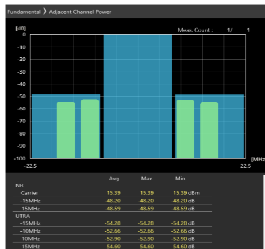
15MHz_30kHz_3692.5MHz-OFDM QPSK_RB1@37 -47,-46.38dB
