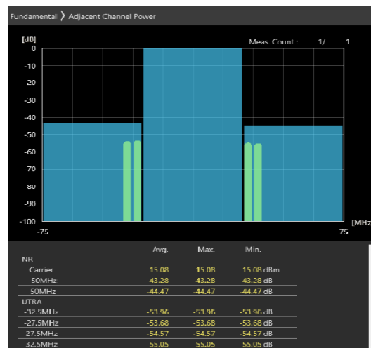
50MHz_30kHz_3675MHz-OFDM QPSK_RB1@132 -41.88,-42.64dB
