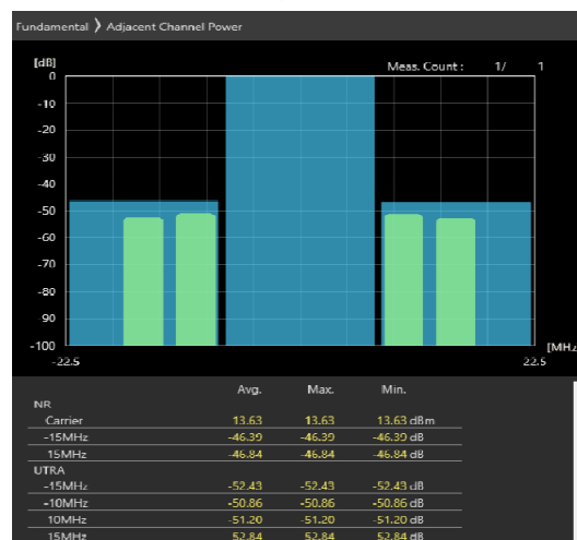
15MHz_30kHz_3692.5MHz-OFDM QPSK_RB36@0 -46.39,-46.84dB
