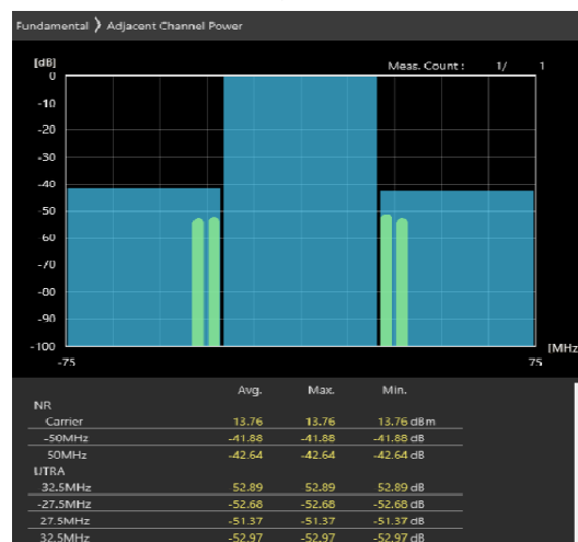
50MHz_30kHz_3675MHz-OFDM QPSK_RB128@0 -41.58,-42.93dB
