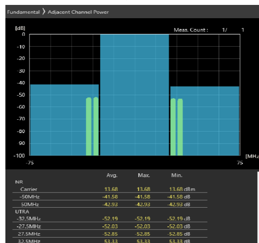
50MHz_30kHz_3675MHz-OFDM QPSK_RB128@0 -41.58,-42.93dB
