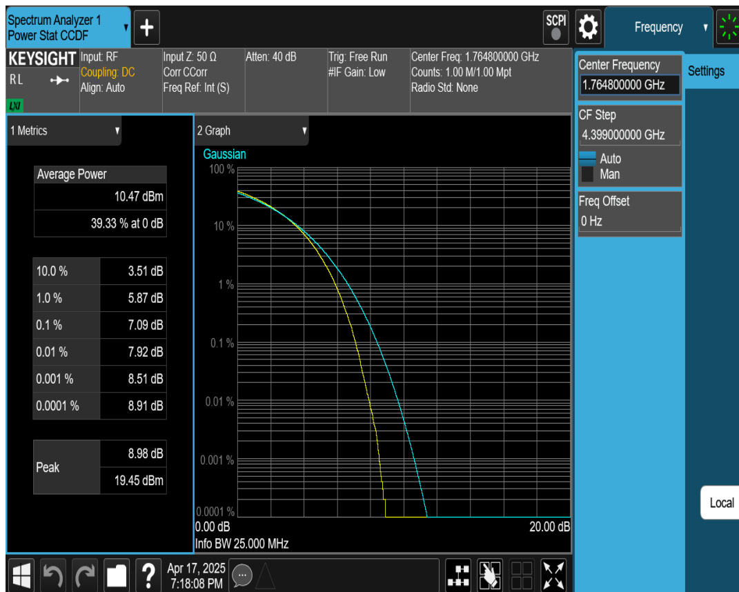
66C QPSK PCC BW=10MHz Ch=66892 RB=50@0,SCC BW=20MHz Ch=67036 RB=100@0
