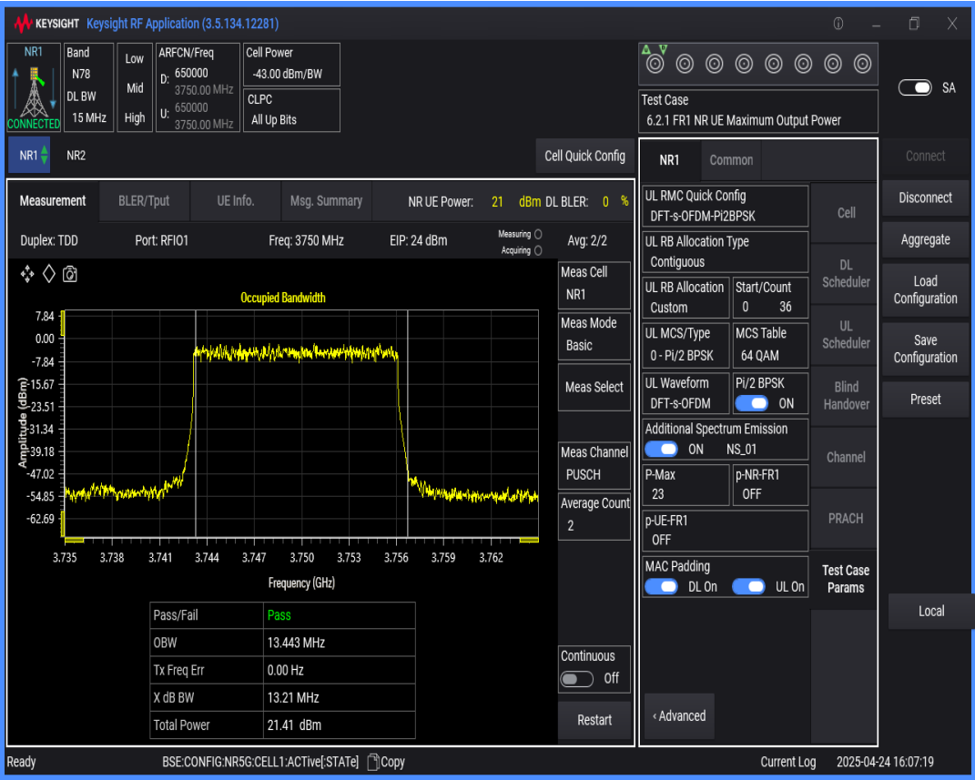
n78(3700-3800) SCS=30kHz DFT_BPSK BW=20MHz Channel=650000 RB=50@0
