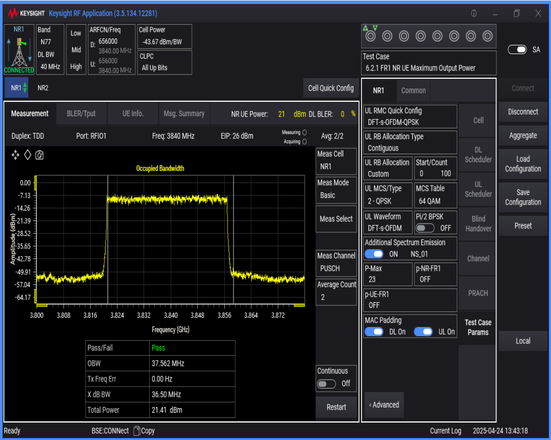
n77(3700-3980) SCS=30kHz DFT_QPSK BW=20MHz Channel=656000 RB=50@0
