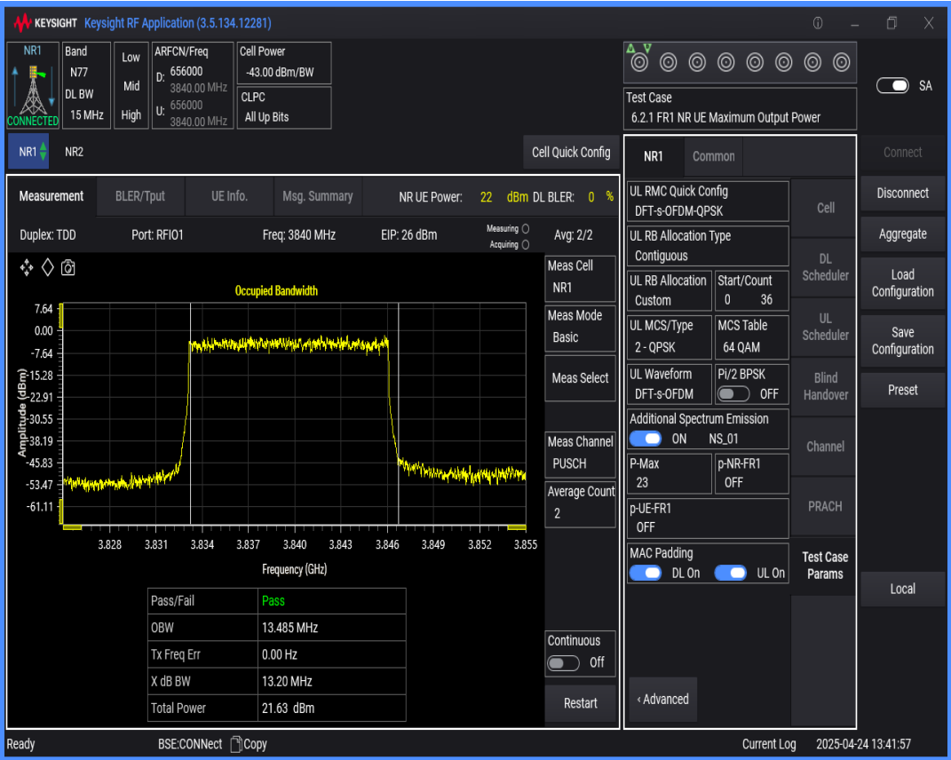
n77(3700-3980) SCS=30kHz DFT_QPSK BW=10MHz Channel=656000 RB=24@0
