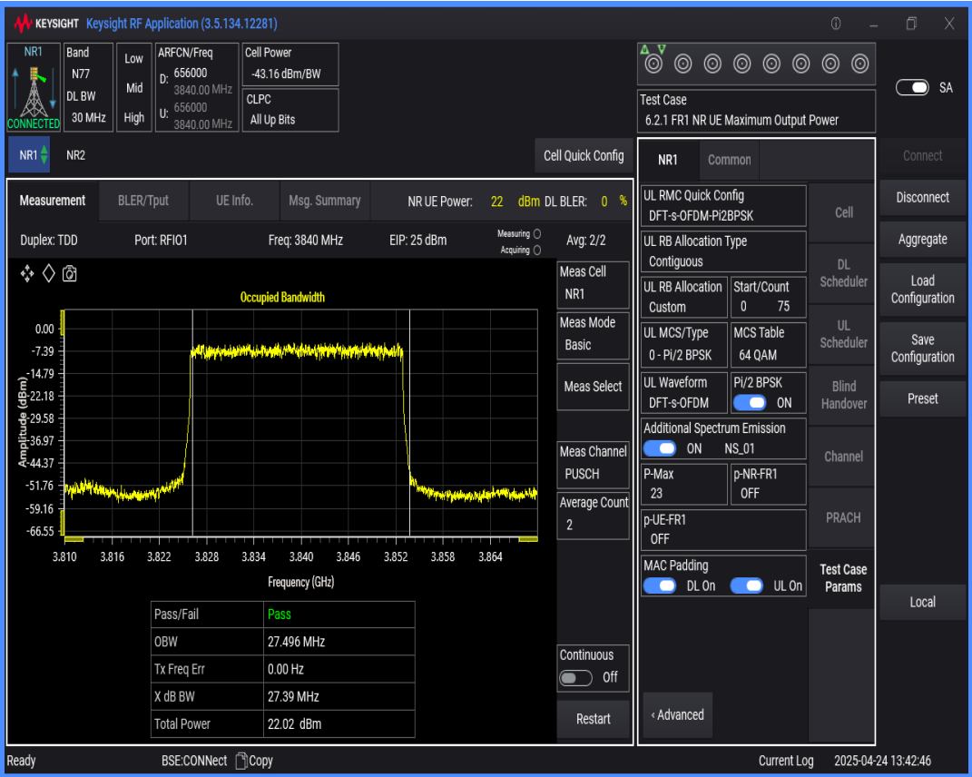
n77(3700-3980) SCS=30kHz DFT_BPSK BW=20MHz Channel=656000 RB=50@0
