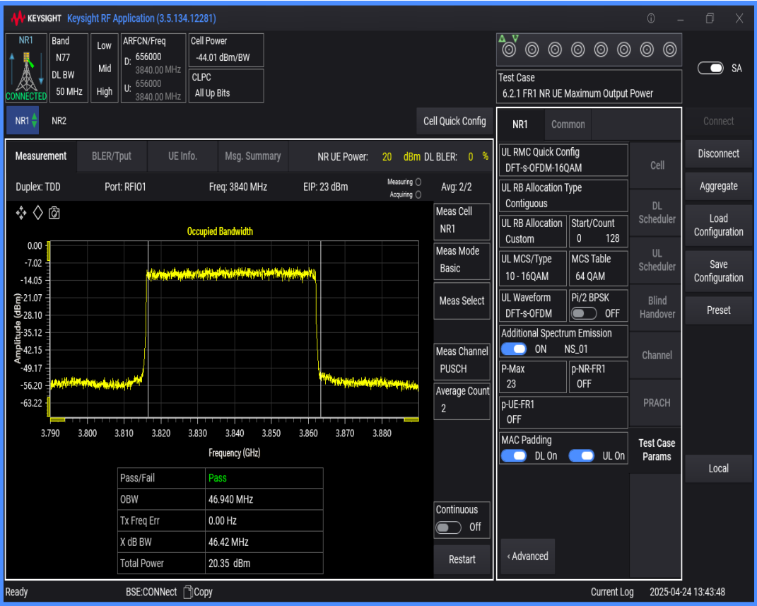
n77(3700-3980) SCS=30kHz DFT_QAM16 BW=20MHz Channel=656000 RB=50@0
