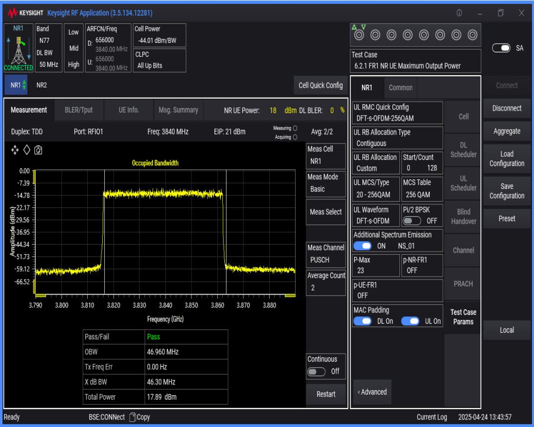
n77(3700-3980) SCS=30kHz DFT_QAM256 BW=20MHz Channel=656000 RB=50@0
