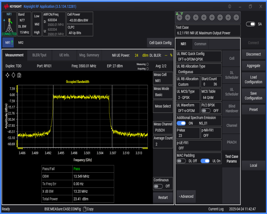
n77(3450-3550) SCS=30kHz DFT_QPSK BW=20MHz Channel=633334 RB=50@0
