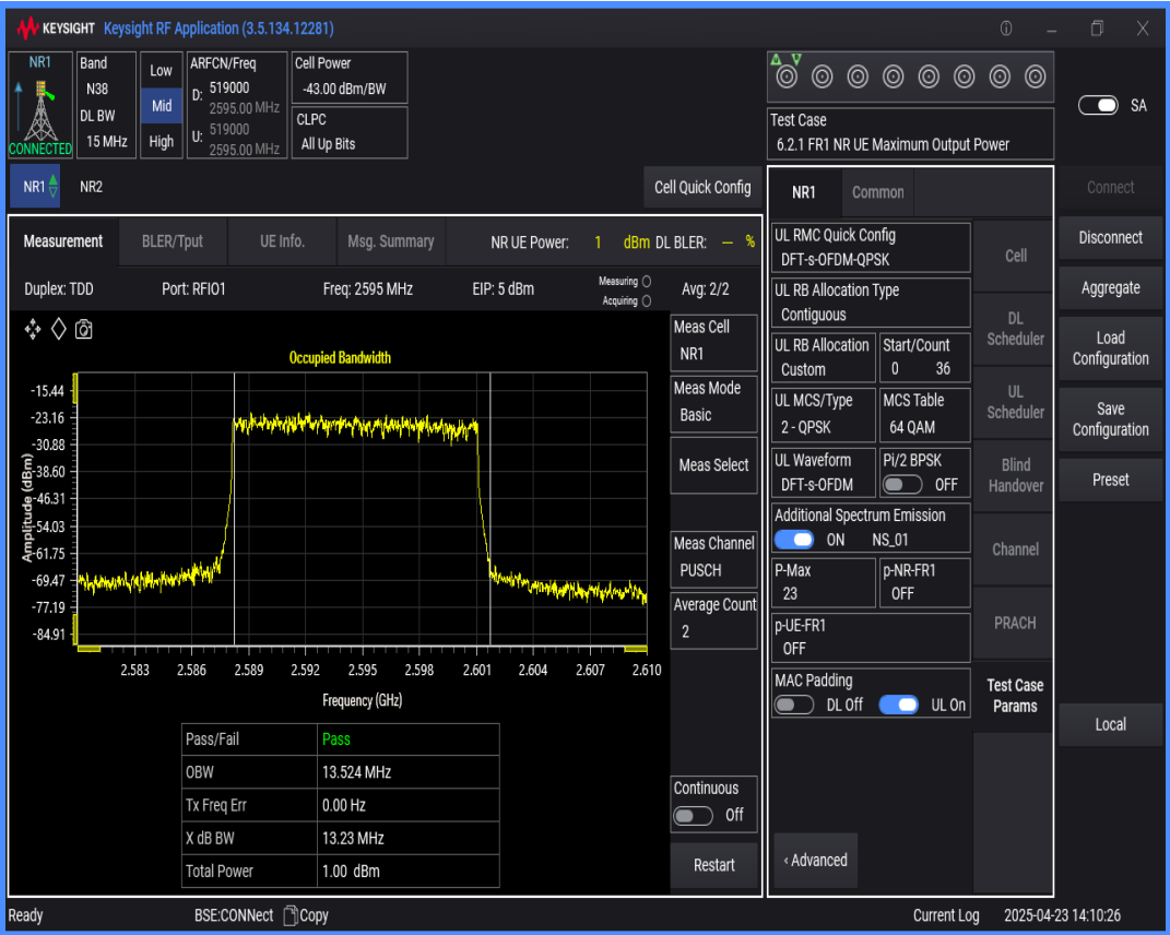
n38 SCS=30kHz DFT_QPSK BW=10MHz Channel=519000 RB=24@0
