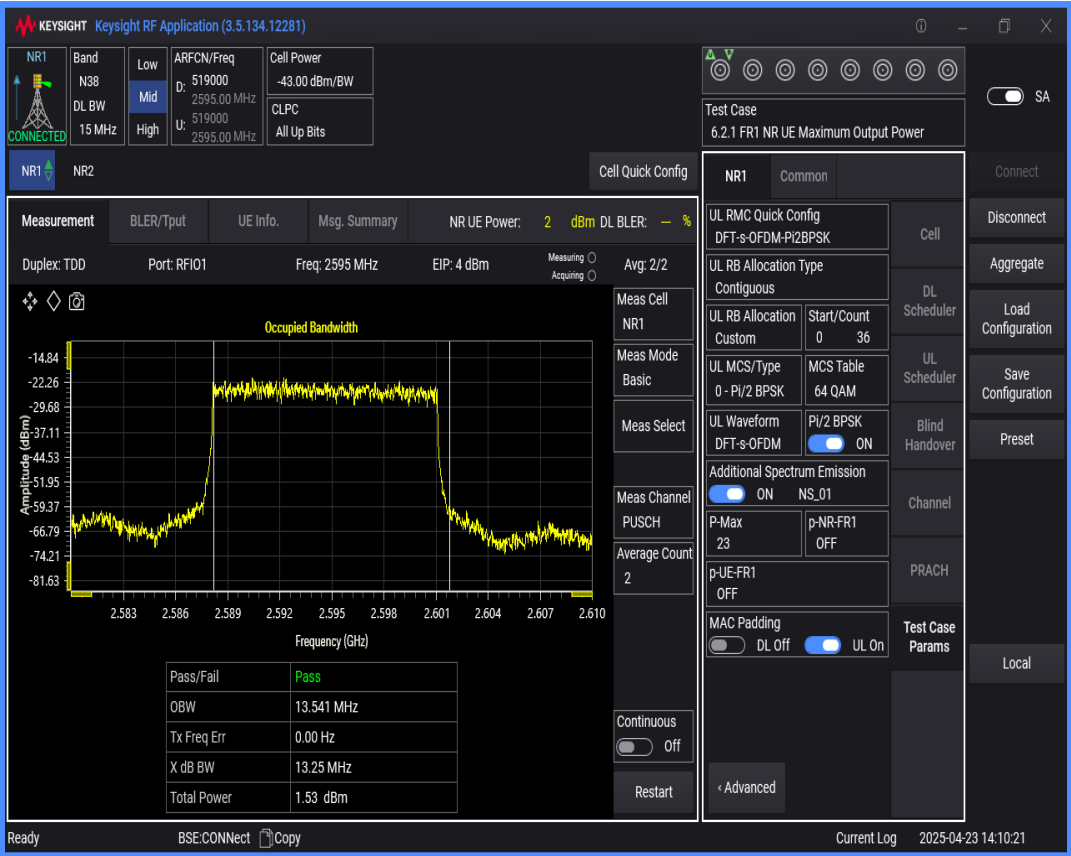
n38 SCS=30kHz DFT_BPSK BW=20MHz Channel=519000 RB=50@0
