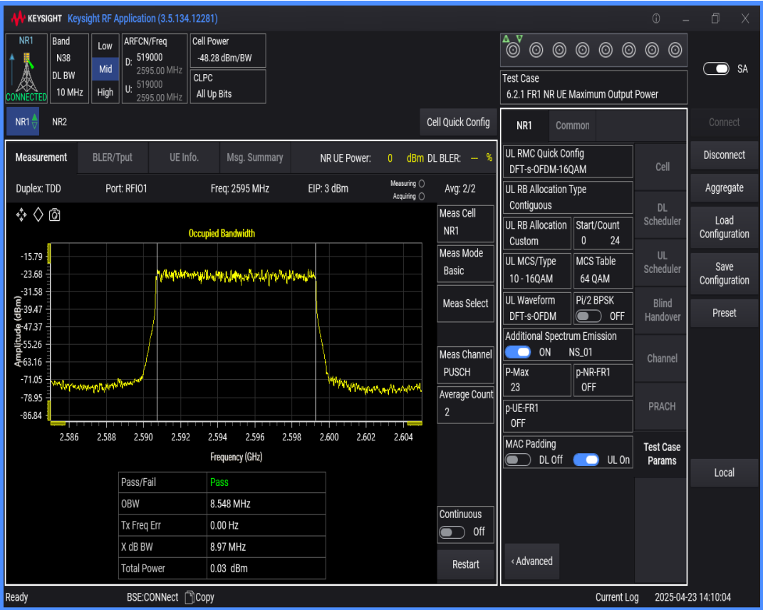
n38 SCS=30kHz DFT_QAM256 BW=10MHz Channel=519000 RB=24@0
