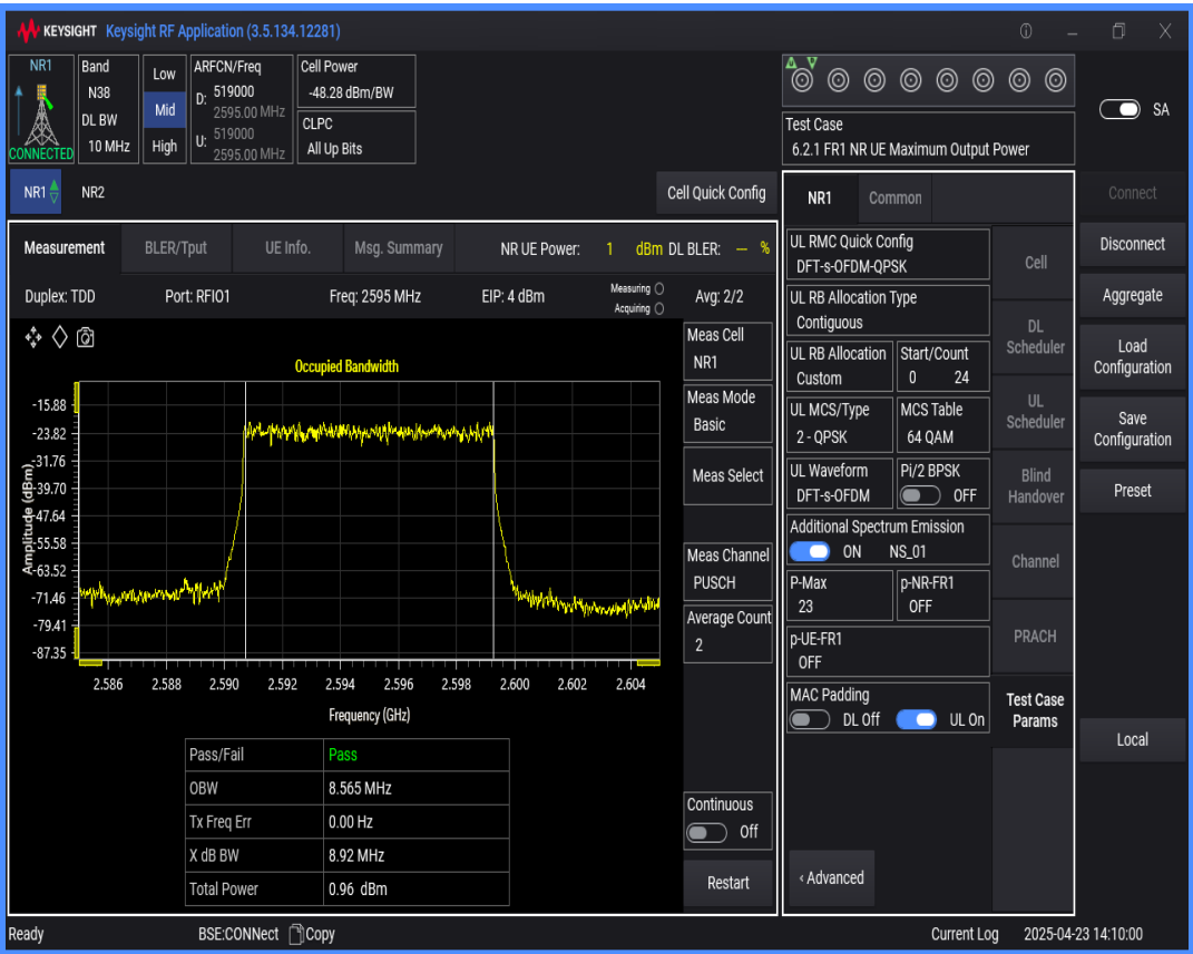
n38 SCS=30kHz DFT_QAM64 BW=20MHz Channel=519000 RB=50@0
