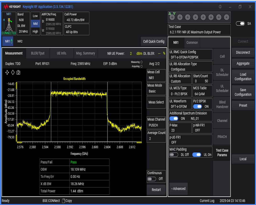
n38 SCS=30kHz DFT_QAM16 BW=20MHz Channel=519000 RB=50@0
