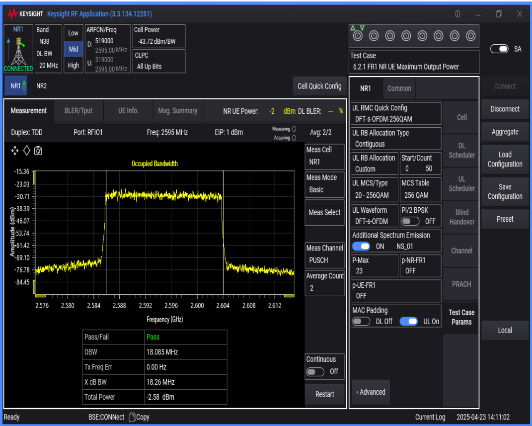
n38 SCS=30kHz DFT_QPSK BW=15MHz Channel=519000 RB=36@0
