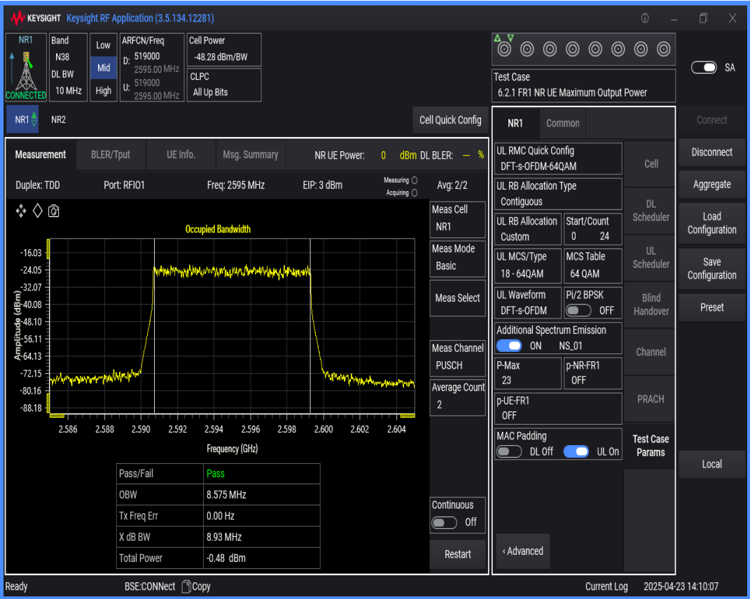
n38 SCS=30kHz DFT_QAM256 BW=20MHz Channel=519000 RB=50@0
