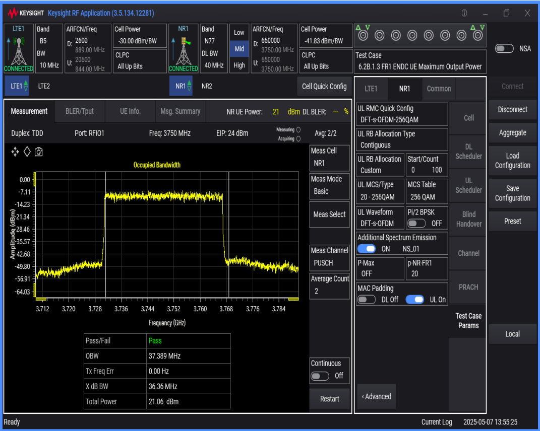
n77 SCS=30kHz DFT_QAM256 BW=20MHz Channel=650000 RB=50@0
