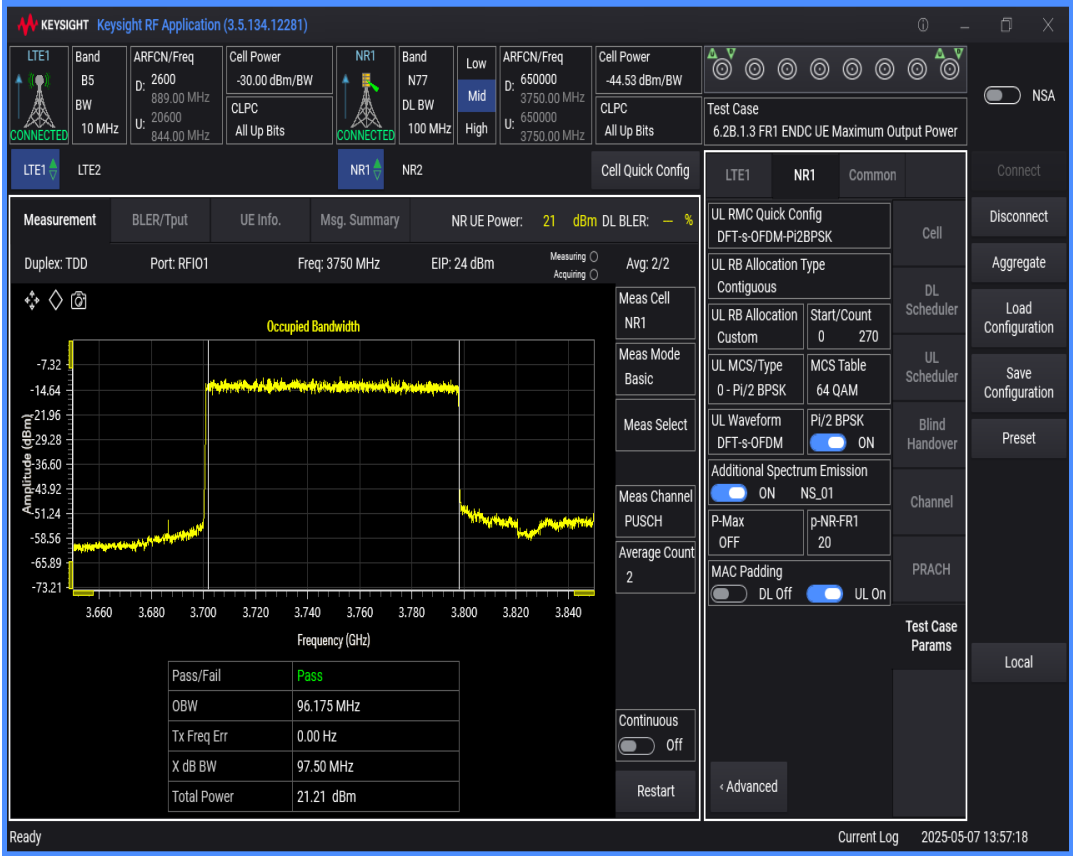
n77 SCS=30kHz DFT_BPSK BW=20MHz Channel=650000 RB=50@0
