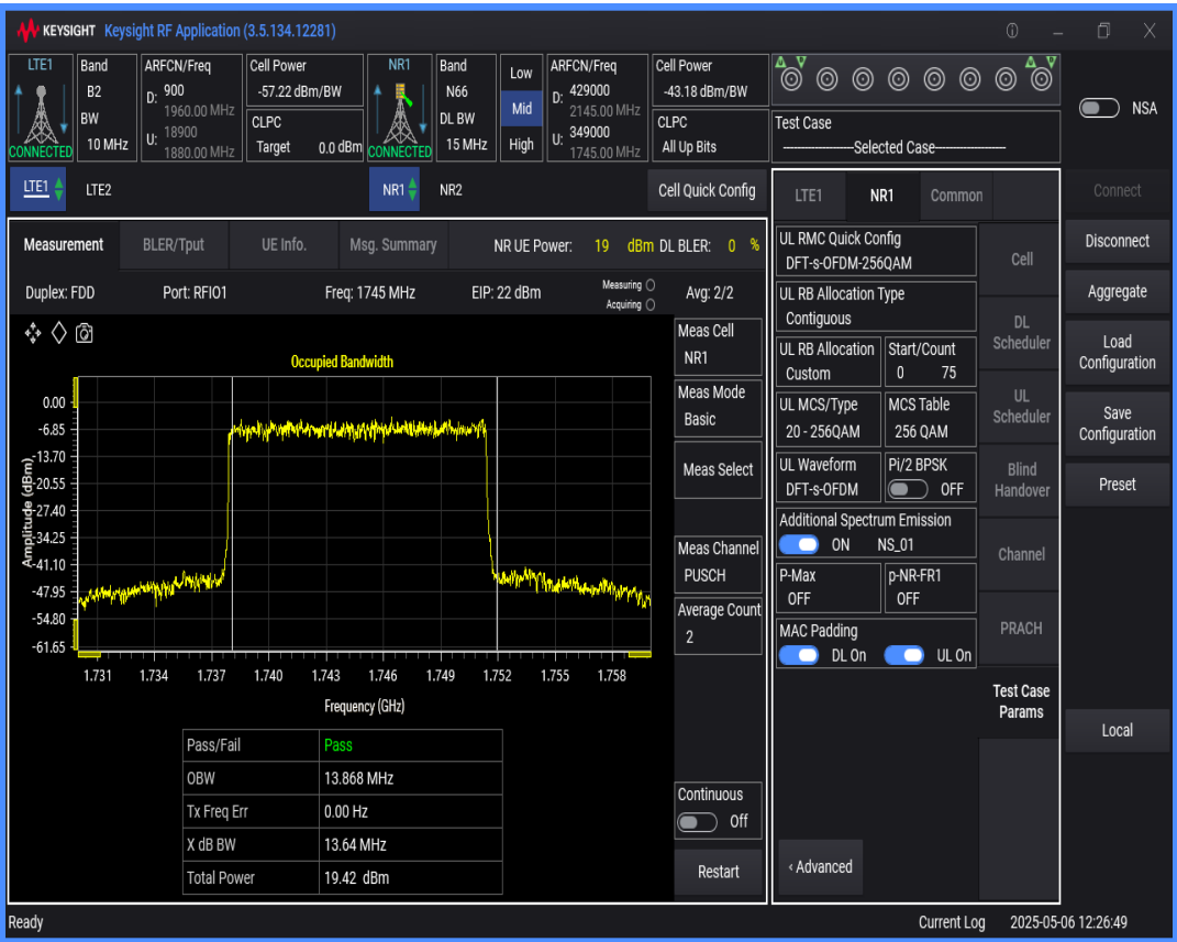
n66 SCS=15kHz DFT_QPSK BW=20MHz Channel=349000 RB=100@0
