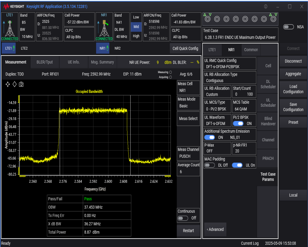
n41 SCS=30kHz DFT_QAM256 BW=20MHz Channel=518598 RB=50@0
