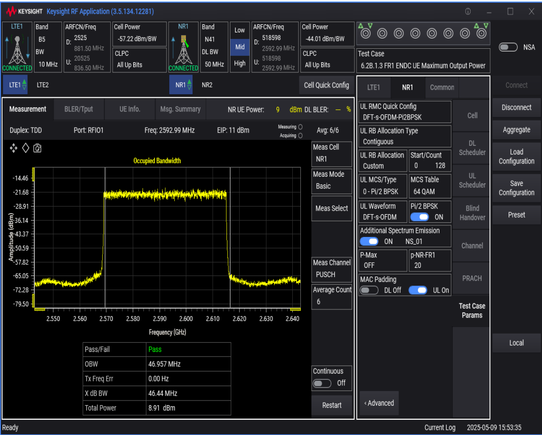
n41 SCS=30kHz DFT_BPSK BW=40MHz Channel=518598 RB=100@0
