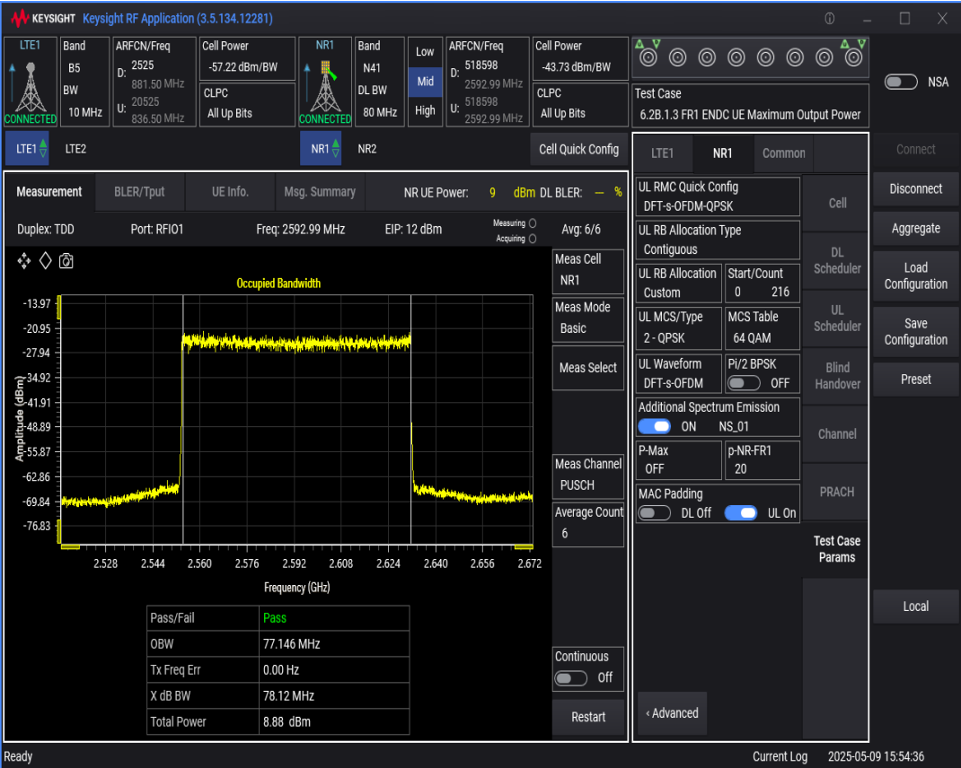
n41 SCS=30kHz DFT_QPSK BW=90MHz Channel=518598 RB=240@0
