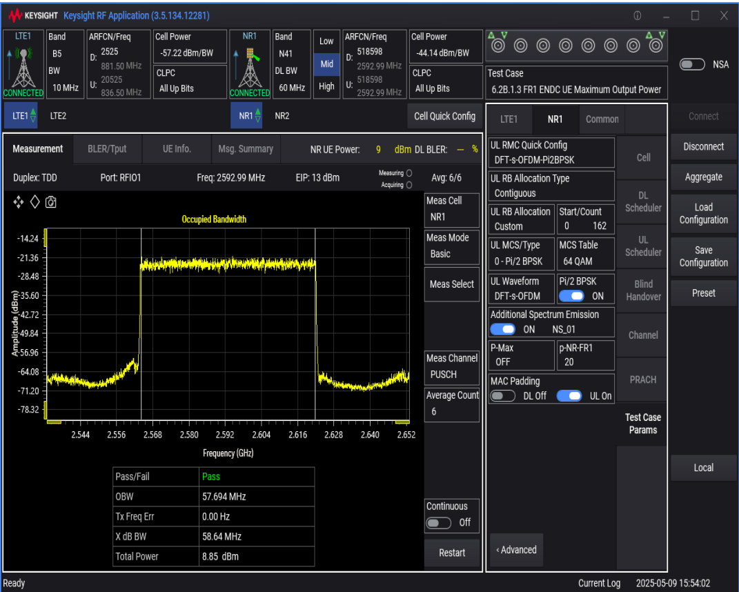
n41 SCS=30kHz DFT_BPSK BW=20MHz Channel=518598 RB=50@0
