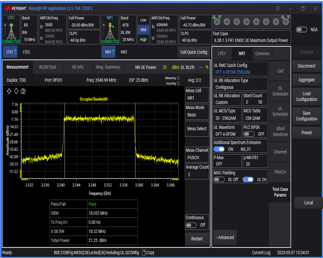
n78 SCS=30kHz DFT_QAM64 BW=20MHz Channel=636666 RB=50@0
