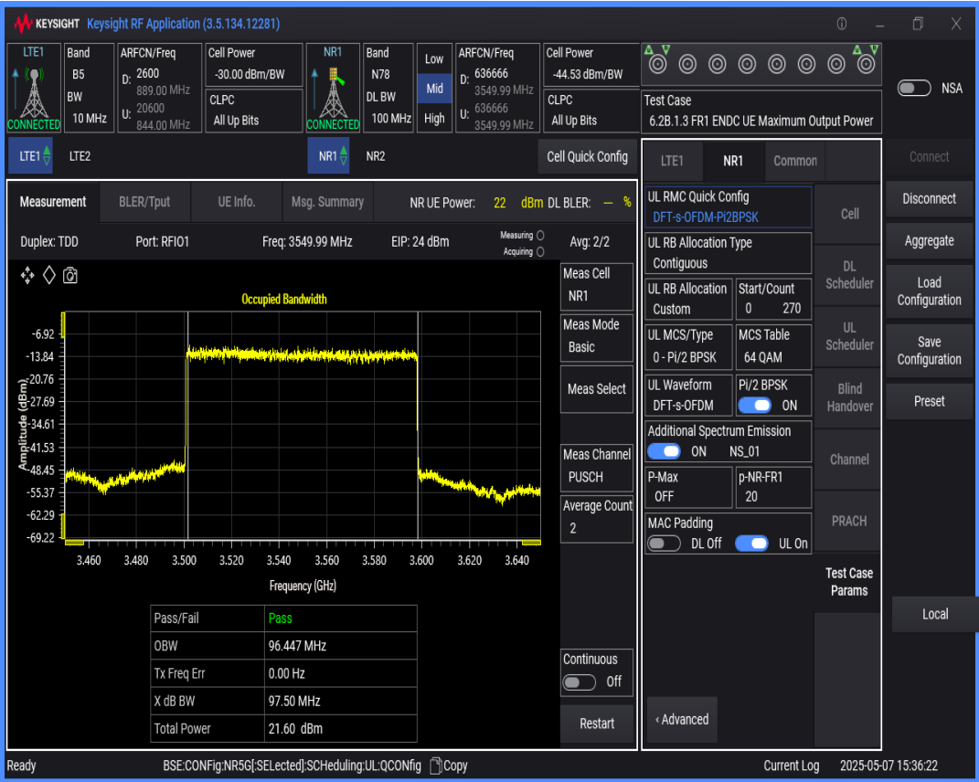
n78 SCS=30kHz DFT_BPSK BW=20MHz Channel=636666 RB=50@0
