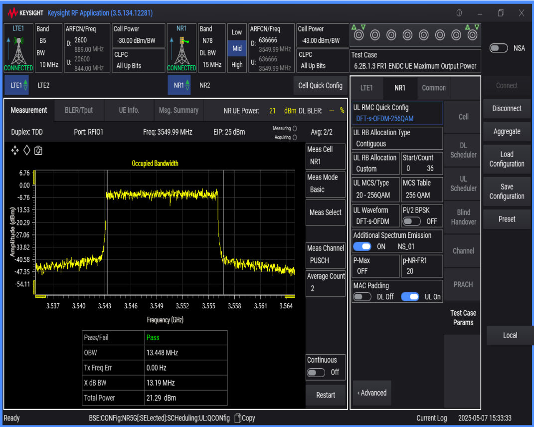
n78 SCS=30kHz DFT_QAM256 BW=20MHz Channel=636666 RB=50@0
