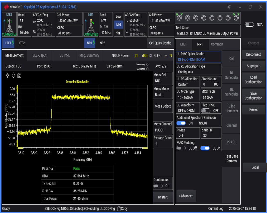
n78 SCS=30kHz DFT_QAM16 BW=20MHz Channel=636666 RB=50@0
