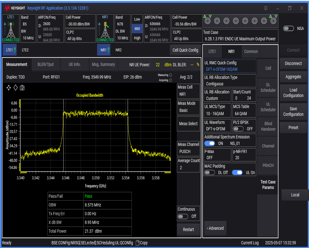
n78 SCS=30kHz DFT_BPSK BW=20MHz Channel=636666 RB=50@0
