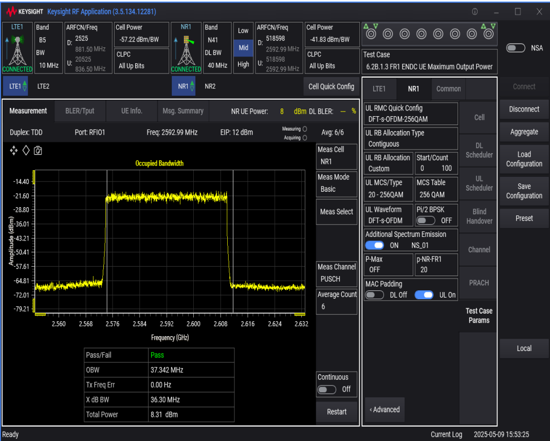
n41 SCS=30kHz DFT_QAM256 BW=20MHz Channel=518598 RB=50@0
