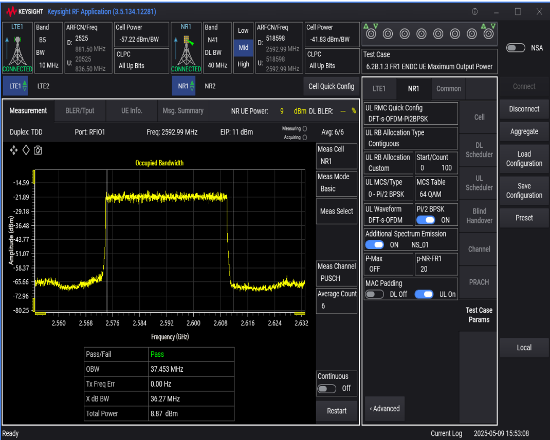
n41 SCS=30kHz DFT_BPSK BW=20MHz Channel=518598 RB=50@0
