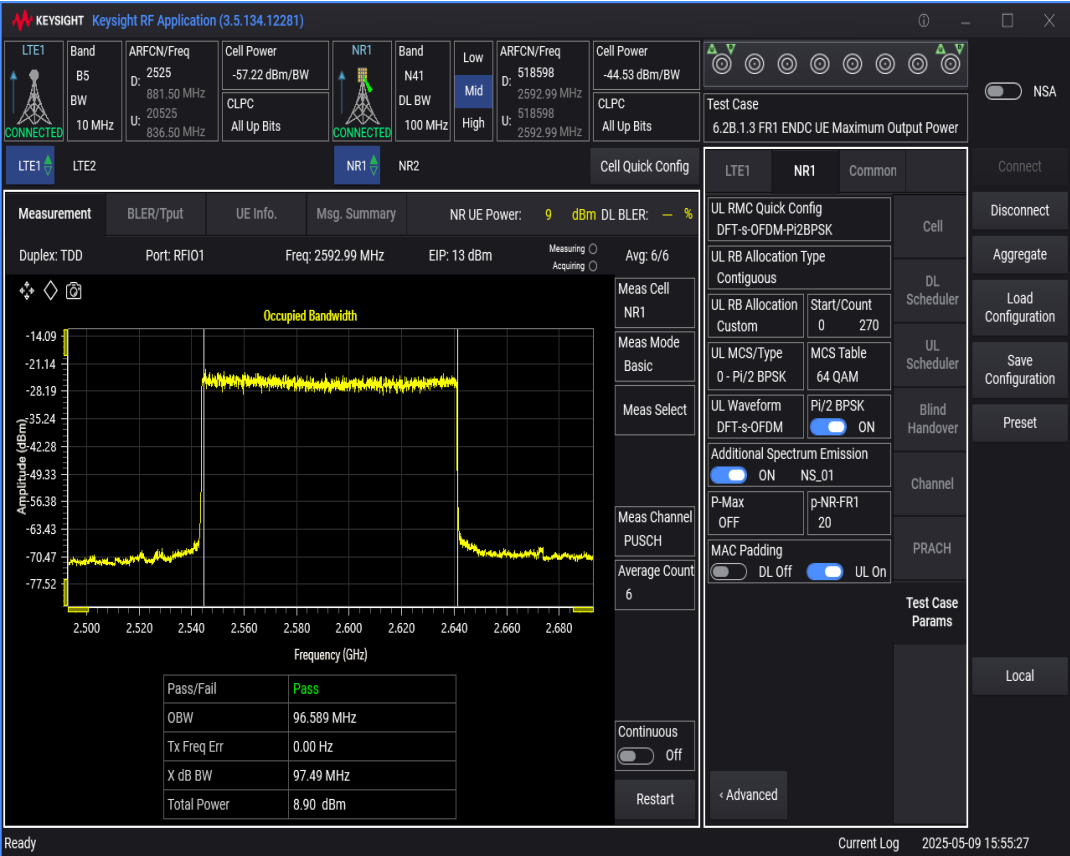
n41 SCS=30kHz DFT_BPSK BW=40MHz Channel=518598 RB=100@0
