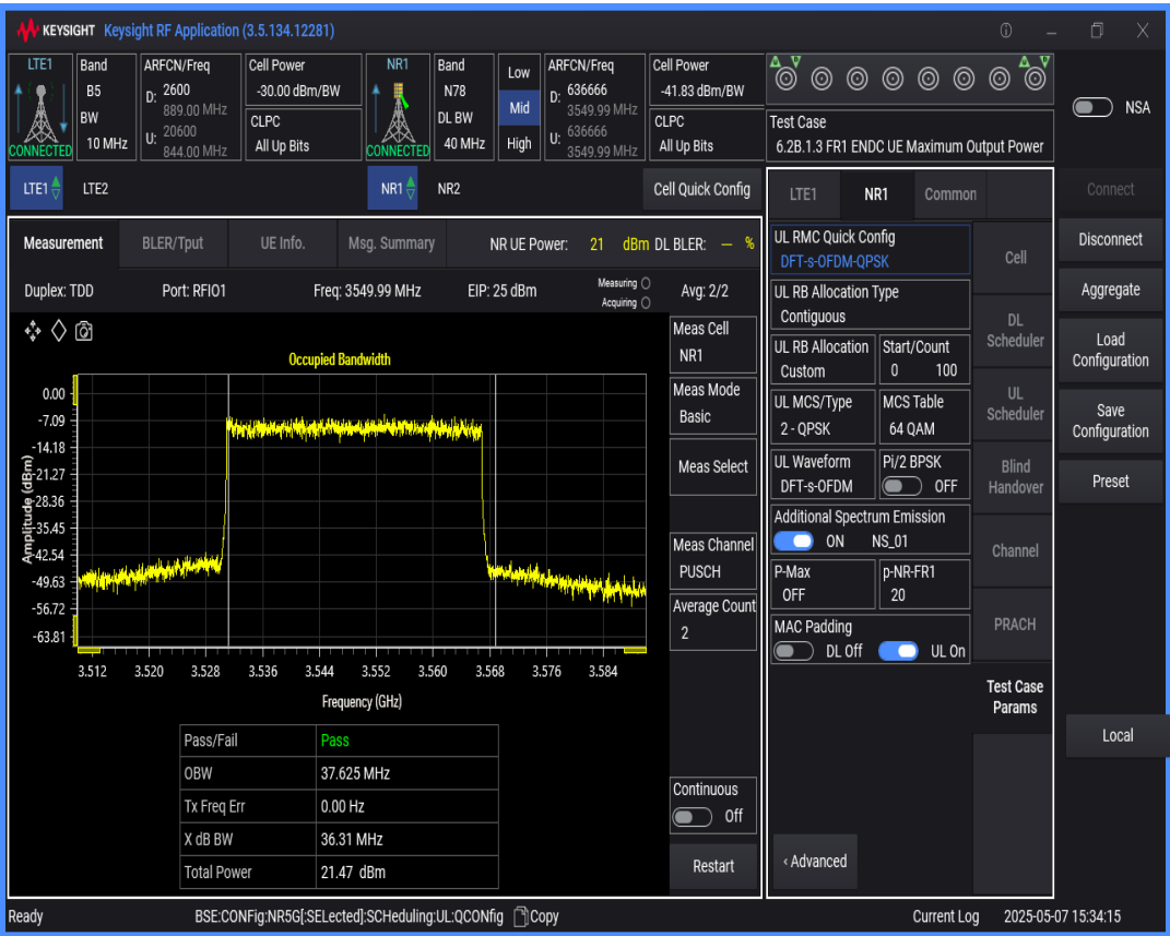
n78 SCS=30kHz DFT_QPSK BW=20MHz Channel=636666 RB=50@0
