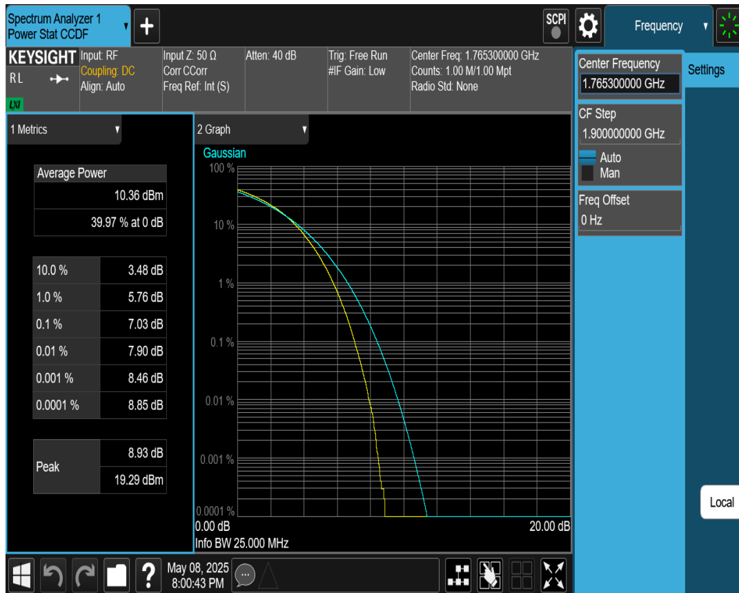
66C 16QAM PCC BW=10MHz Ch=66792 RB=50@0,SCC BW=20MHz Ch=66936 RB=100@0
