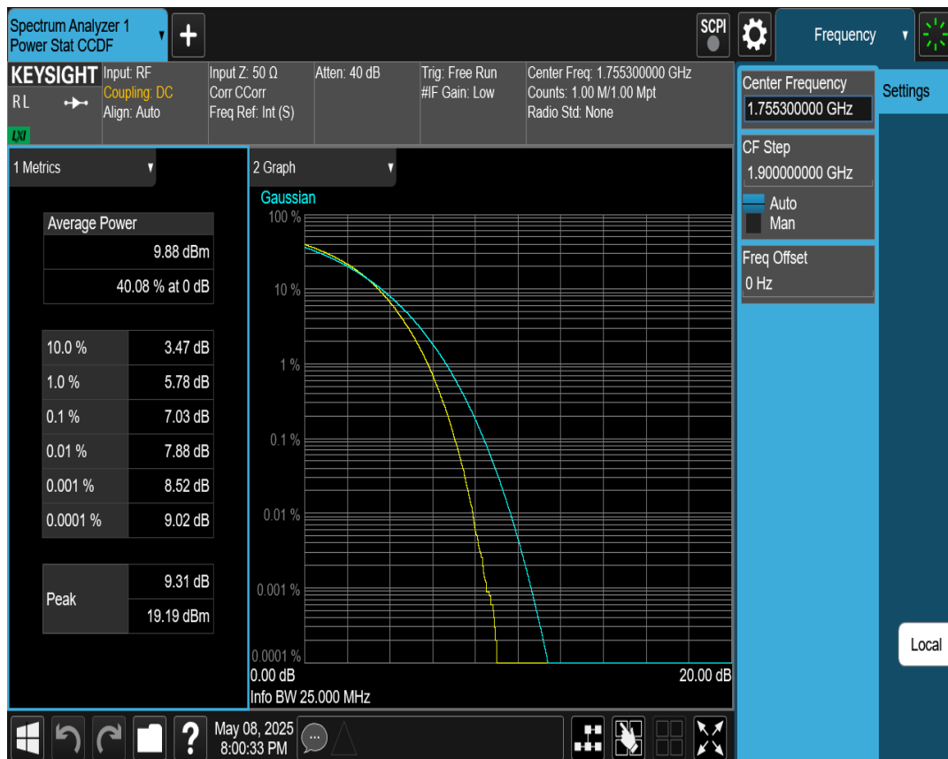
66C 16QAM PCC BW=10MHz Ch=66491 RB=50@0,SCC BW=20MHz Ch=66635 RB=100@0
