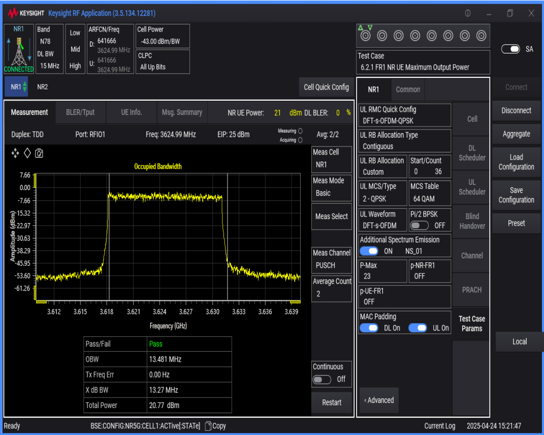
n78(3550-3700) SCS=30kHz DFT_QPSK BW=20MHz Channel=641666 RB=50@0
