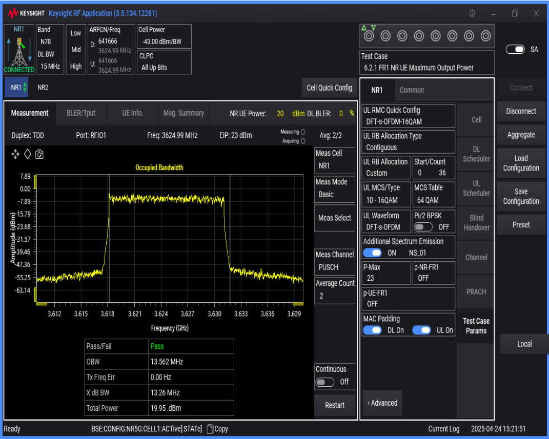
n78(3550-3700) SCS=30kHz DFT_QAM16 BW=20MHz Channel=641666 RB=50@0
