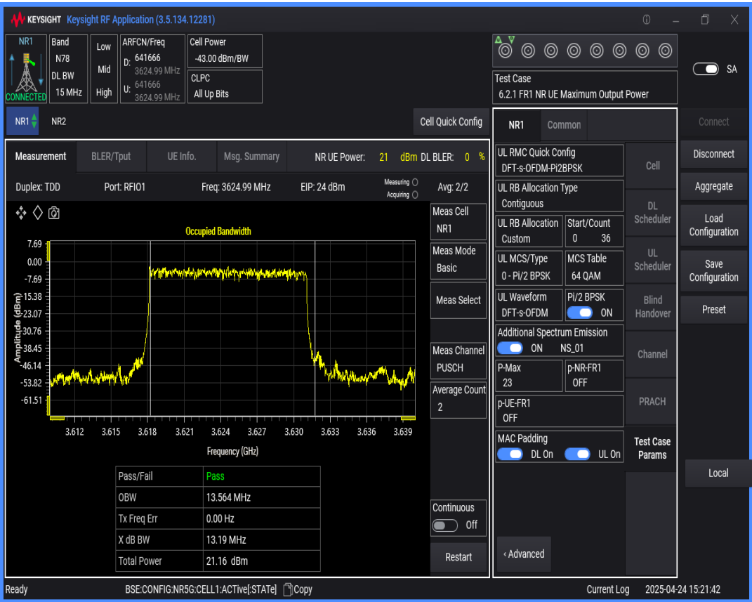
n78(3550-3700) SCS=30kHz DFT_BPSK BW=20MHz Channel=641666 RB=50@0
