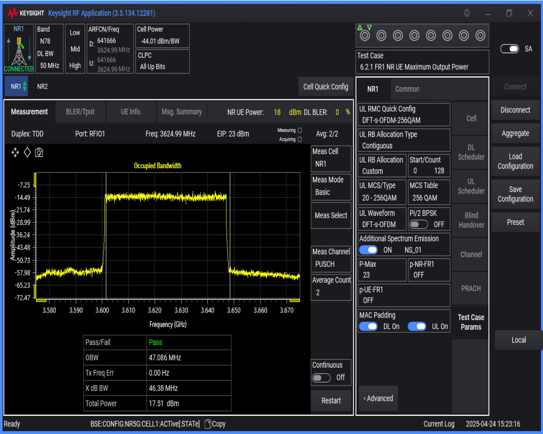
n78(3550-3700) SCS=30kHz DFT_QAM256 BW=20MHz Channel=641666 RB=50@0
