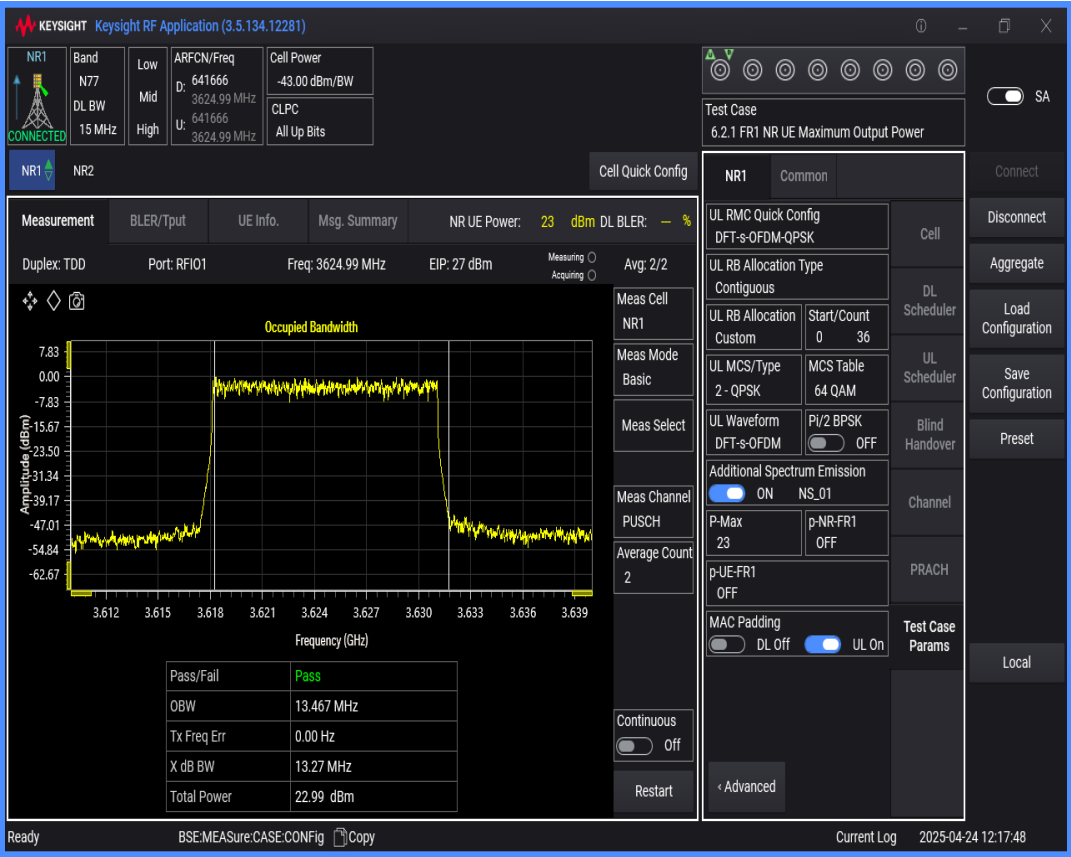
n77(3550-3700) SCS=30kHz DFT_QPSK BW=20MHz Channel=641666 RB=50@0
