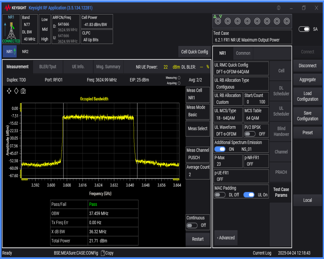
n77(3550-3700) SCS=30kHz DFT_QAM64 BW=20MHz Channel=641666 RB=50@0
