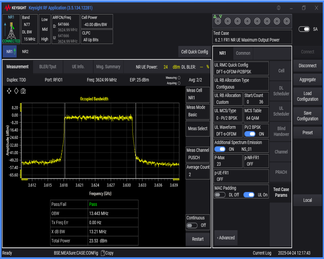
n77(3550-3700) SCS=30kHz DFT_BPSK BW=20MHz Channel=641666 RB=50@0
