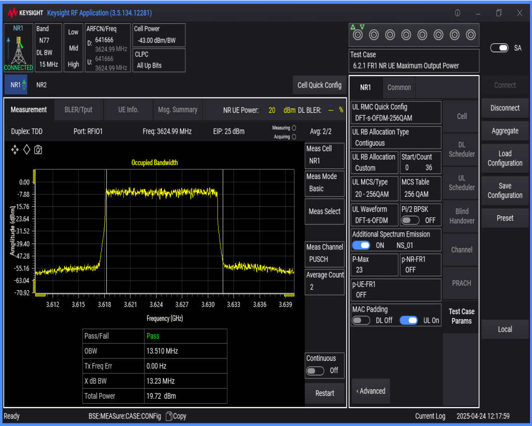
n77(3550-3700) SCS=30kHz DFT_QAM256 BW=20MHz Channel=641666 RB=50@0
