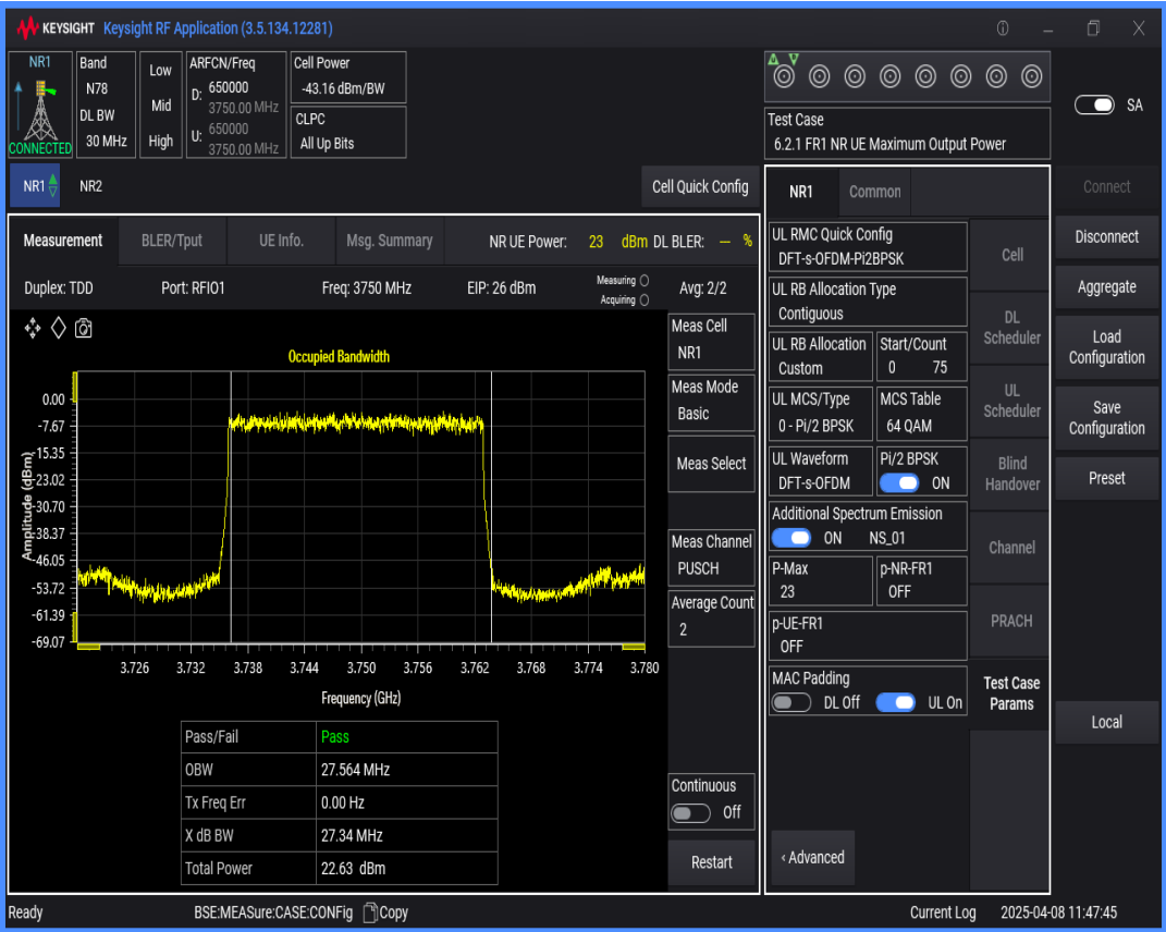
n78(3700-3800) SCS=30kHz DFT_BPSK BW=20MHz Channel=650000 RB=50@0
