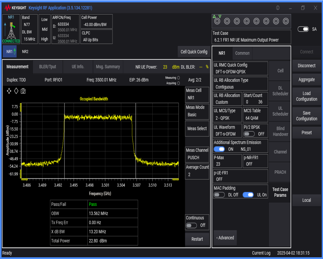
n77(3450-3550) SCS=30kHz DFT_QPSK BW=20MHz Channel=633334 RB=50@0
