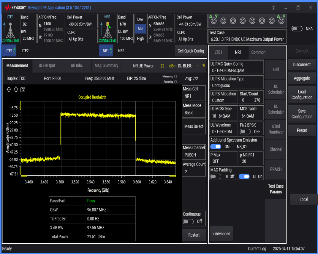
n78 SCS=30kHz DFT_QAM64 BW=20MHz Channel=636666 RB=50@0
