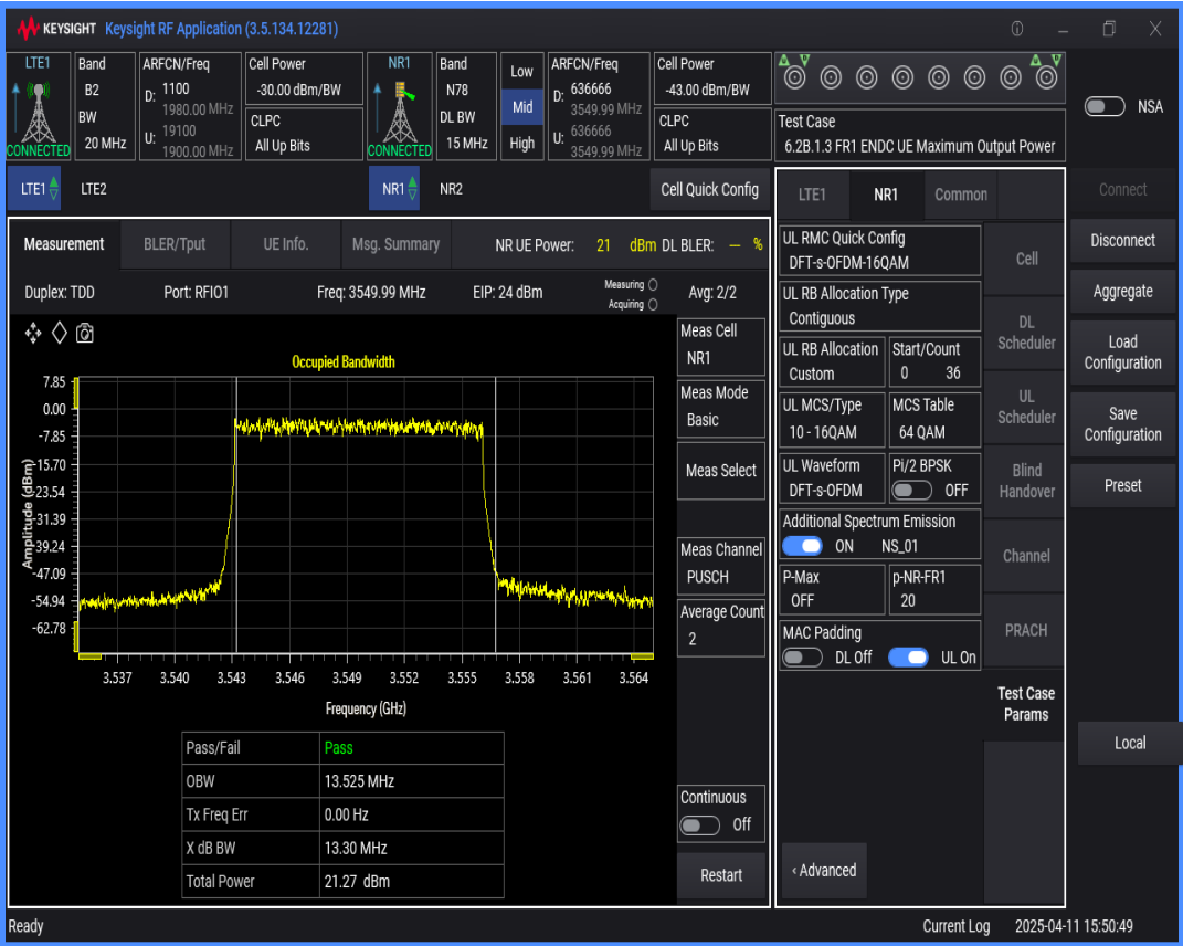
n78 SCS=30kHz DFT_QAM16 BW=20MHz Channel=636666 RB=50@0
