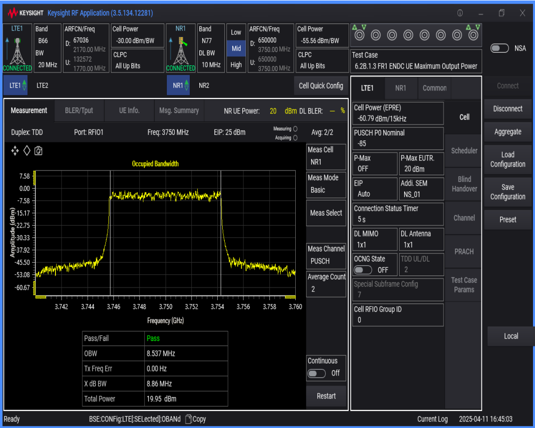
n77 SCS=30kHz DFT_QAM256 BW=20MHz Channel=650000 RB=50@0
