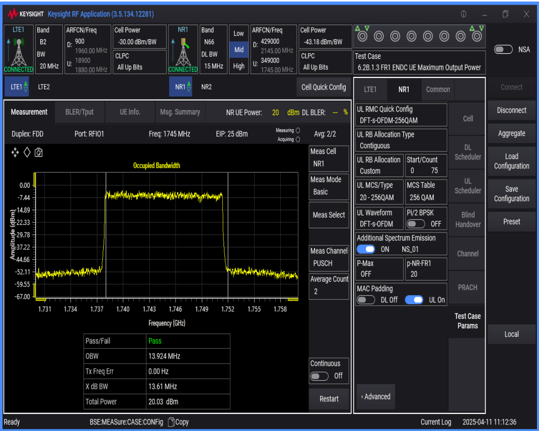
n66 SCS=15kHz DFT_QAM256 BW=10MHz Channel=349000 RB=50@0
