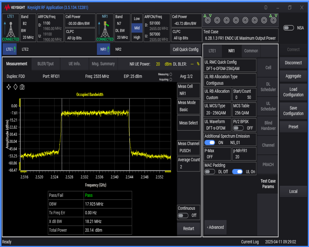
n7 SCS=30kHz DFT_QAM256 BW=10MHz Channel=507000 RB=24@0
