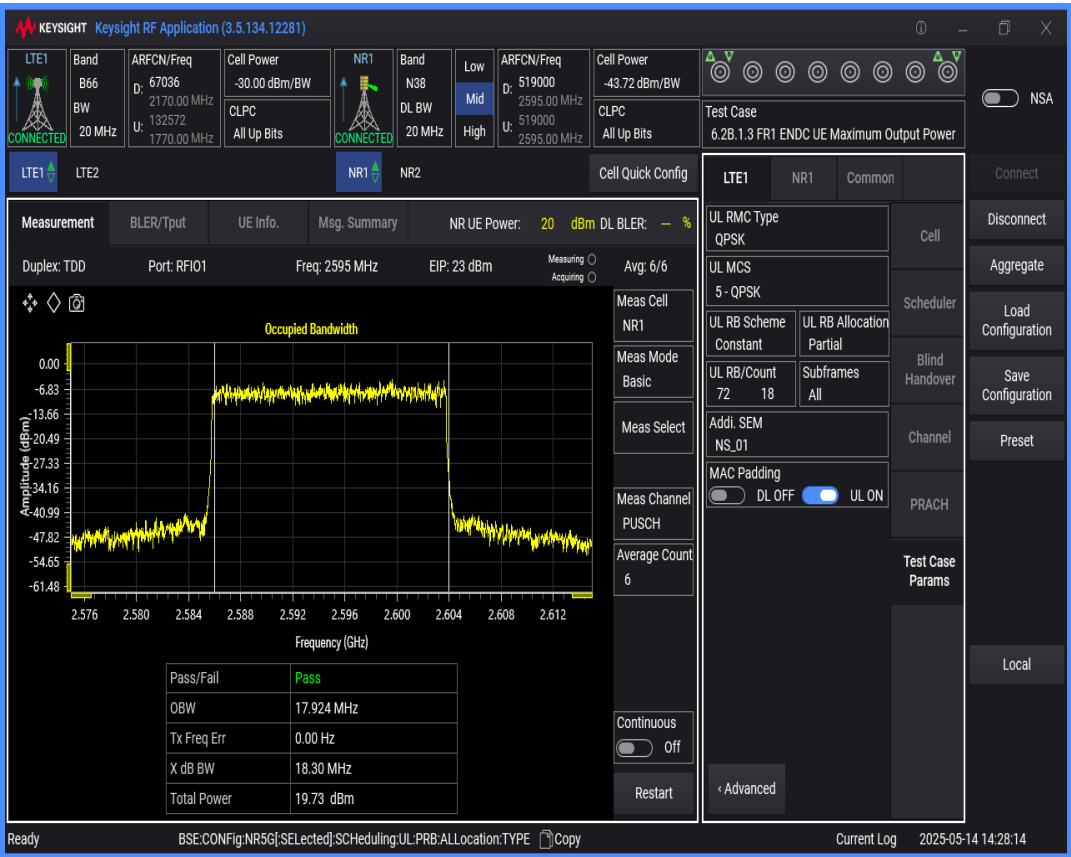
n38 SCS=30kHz DFT_QAM16 BW=20MHz Channel=519000 RB=50@0
