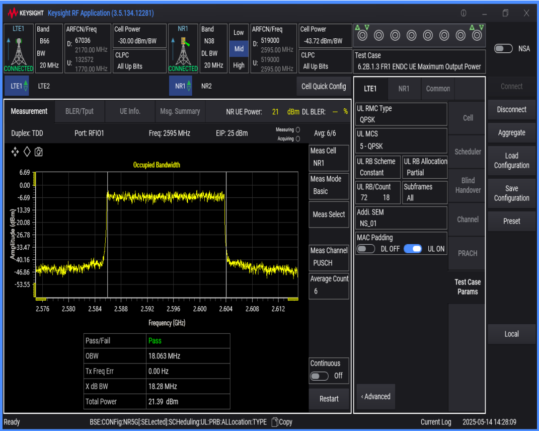
n38 SCS=30kHz DFT_QAM256 BW=20MHz Channel=519000 RB=50@0
