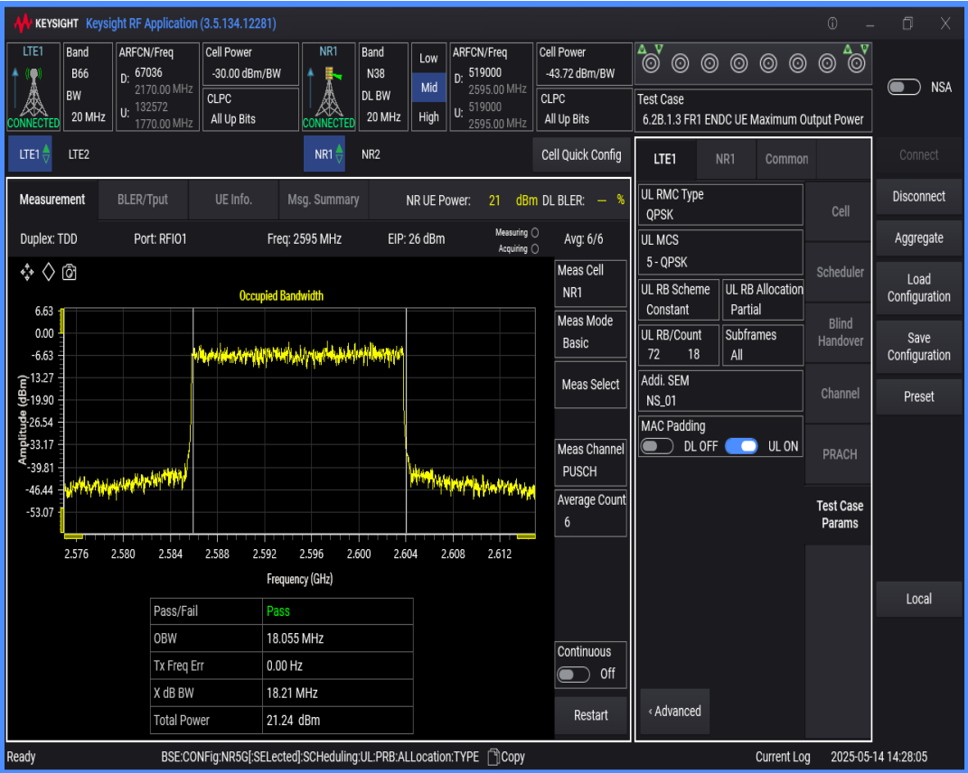
n38 SCS=30kHz DFT_QAM256 BW=10MHz Channel=519000 RB=24@0
