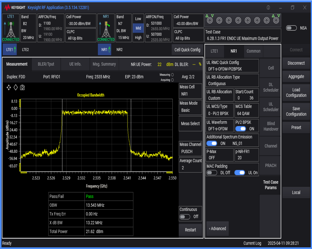
n7 SCS=30kHz DFT_BPSK BW=20MHz Channel=507000 RB=50@0
