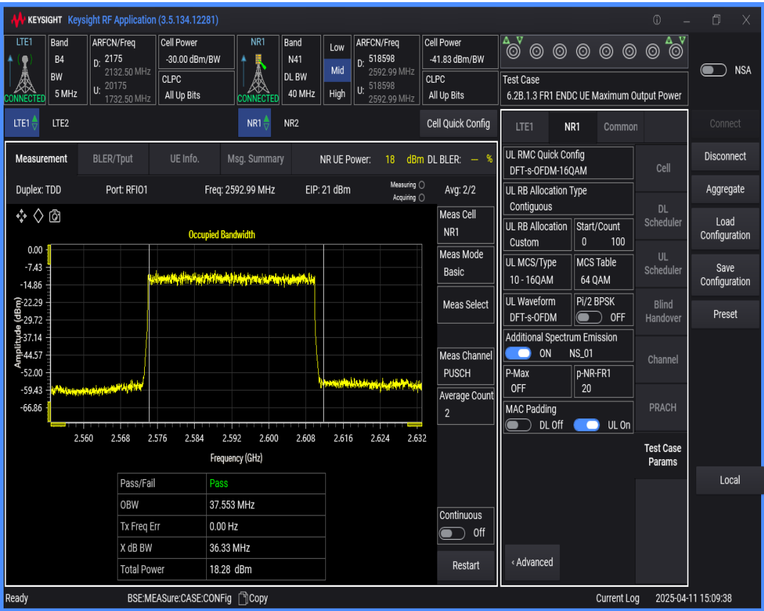
n41 SCS=30kHz DFT_QAM16 BW=20MHz Channel=518598 RB=50@0
