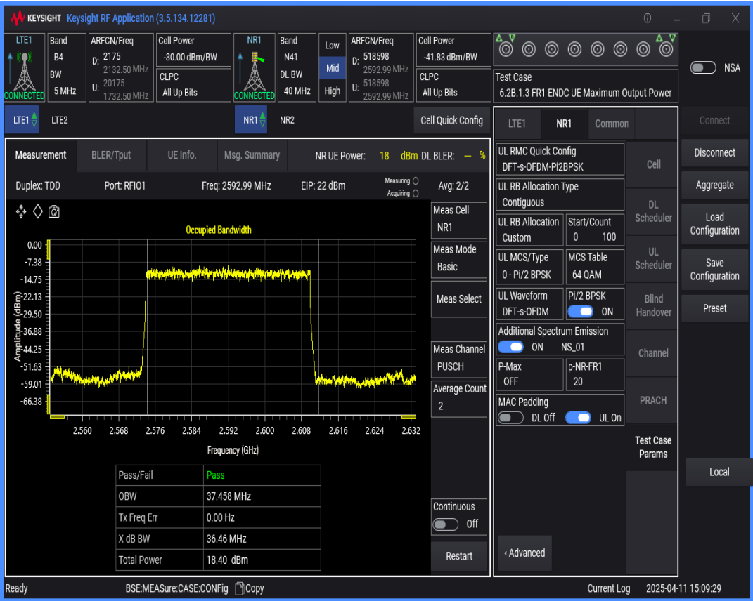
n41 SCS=30kHz DFT_BPSK BW=20MHz Channel=518598 RB=50@0
