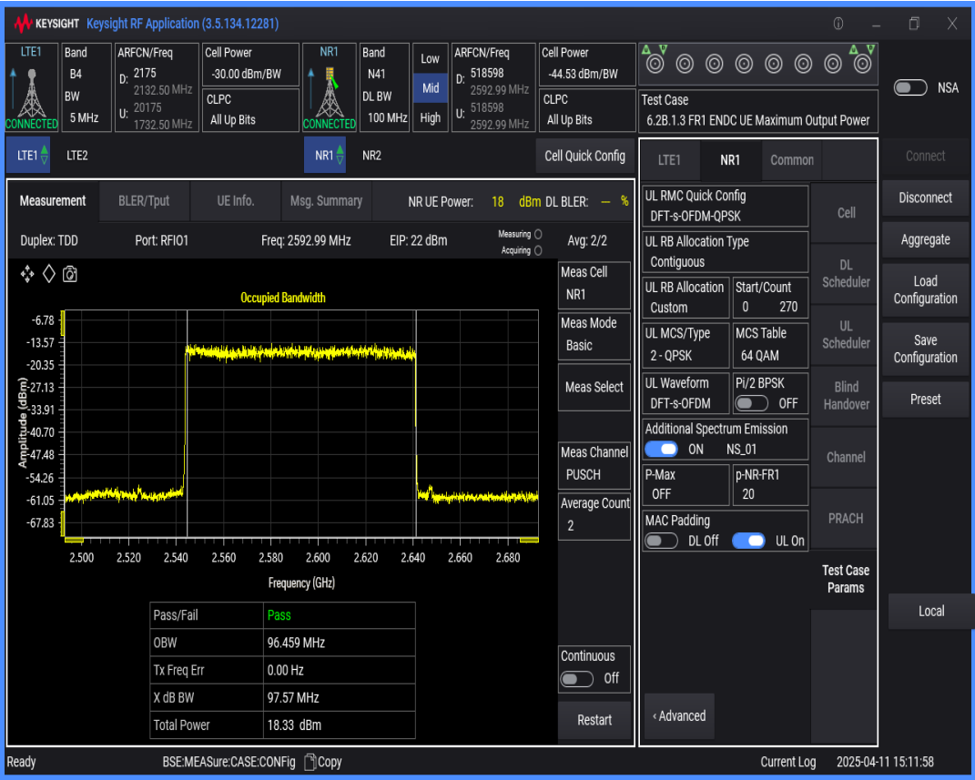
n41 SCS=30kHz DFT_QPSK BW=40MHz Channel=518598 RB=100@0
