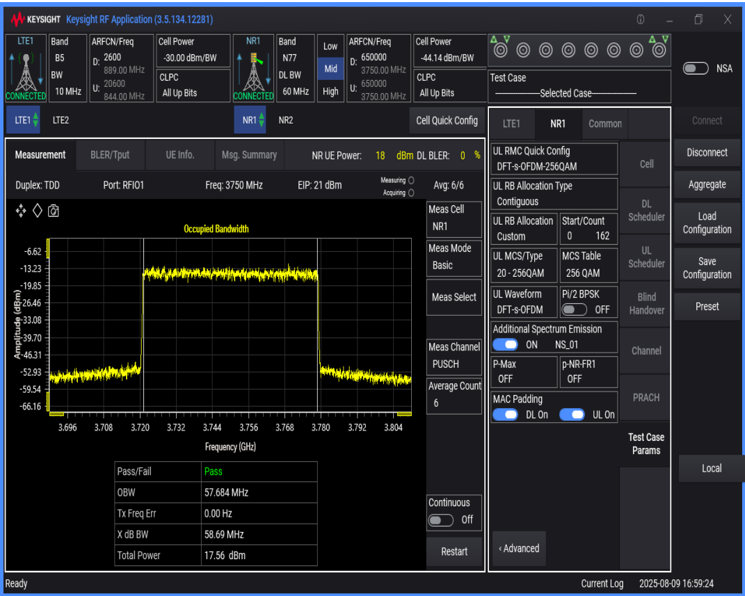
n77 SCS=30kHz DFT_QAM256 BW=20MHz Channel=650000 RB=50@0
