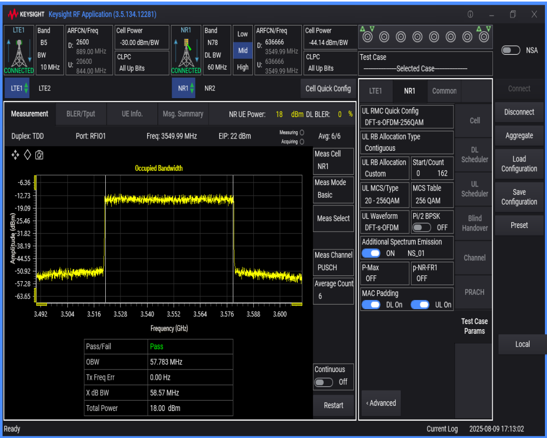
n78 SCS=30kHz DFT_QAM256 BW=20MHz Channel=636666 RB=50@0
