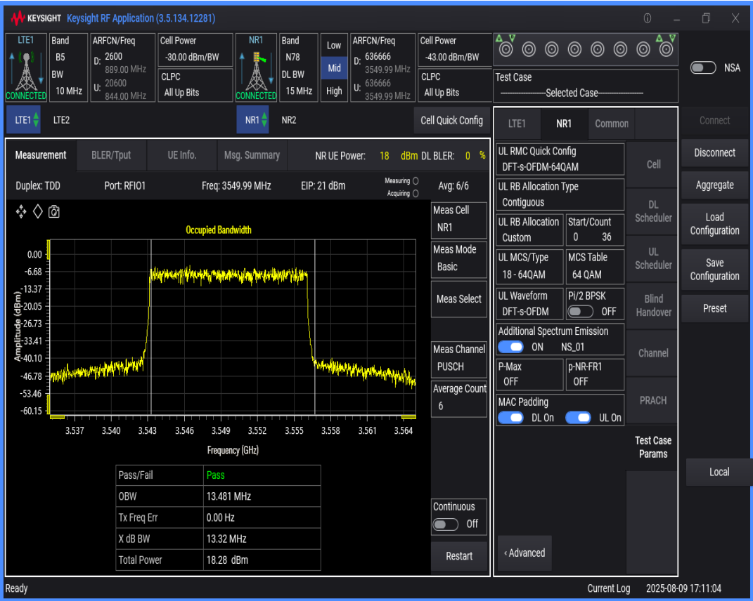
n78 SCS=30kHz DFT_QAM64 BW=20MHz Channel=636666 RB=50@0
