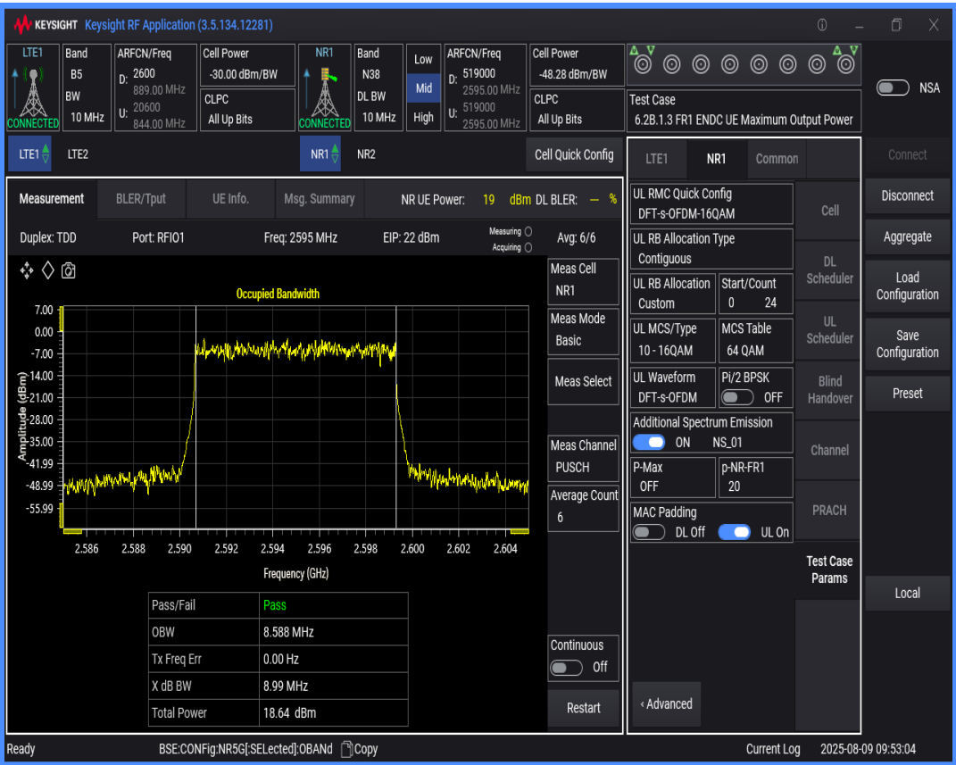
n38 SCS=30kHz DFT_BPSK BW=20MHz Channel=519000 RB=50@0
