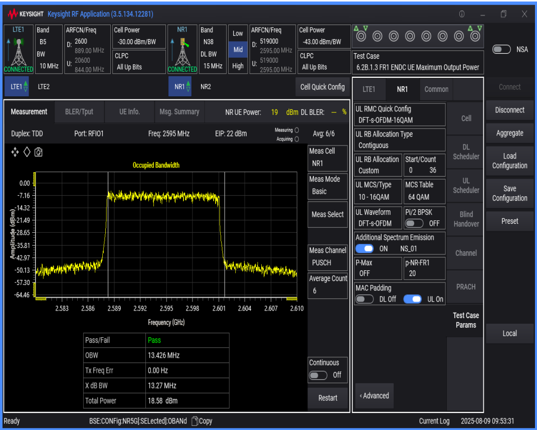
n38 SCS=30kHz DFT_QAM256 BW=10MHz Channel=519000 RB=24@0
