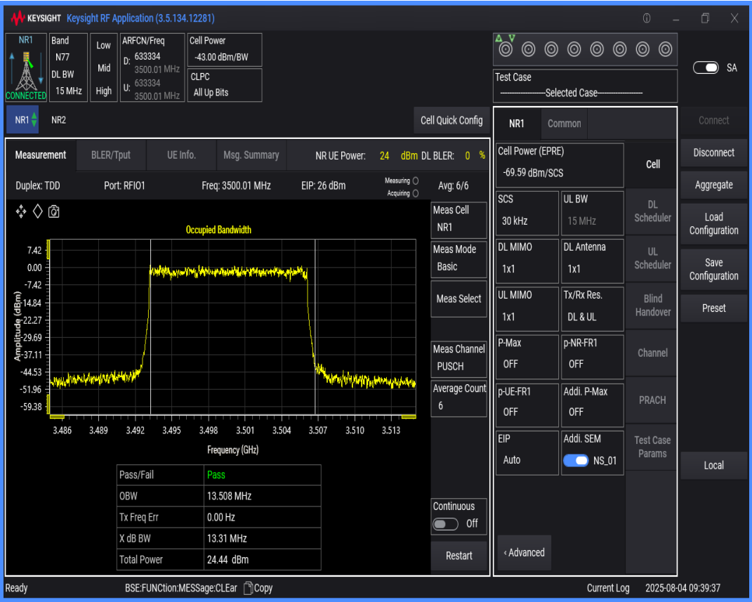
n77(3450-3550) SCS=30kHz DFT_QPSK BW=20MHz Channel=633334 RB=50@0
