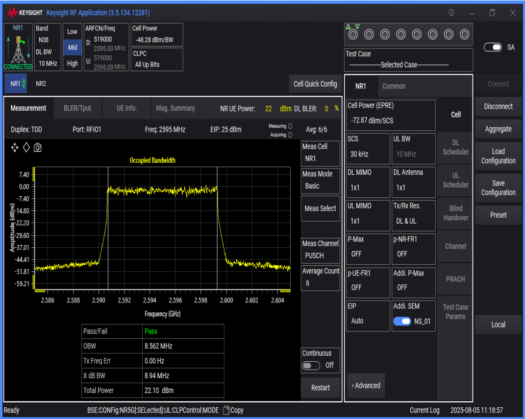
n38 SCS=30kHz DFT_QPSK BW=10MHz Channel=519000 RB=24@0
