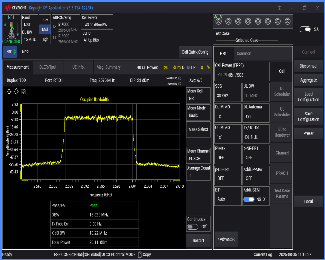
n38 SCS=30kHz DFT_QAM256 BW=10MHz Channel=519000 RB=24@0
