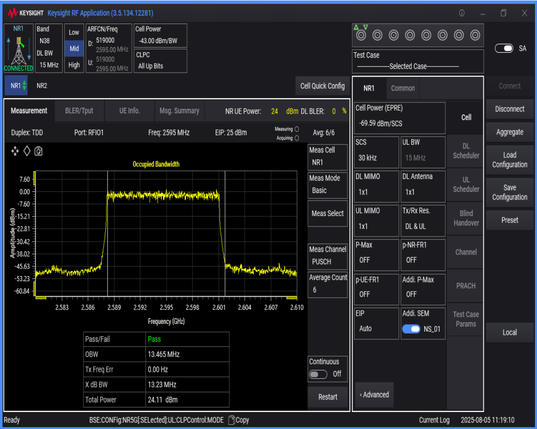
n38 SCS=30kHz DFT_BPSK BW=20MHz Channel=519000 RB=50@0
