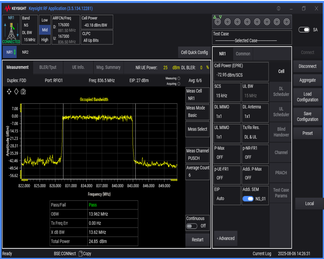
n5 SCS=15kHz DFT_BPSK BW=20MHz Channel=167300 RB=100@0
