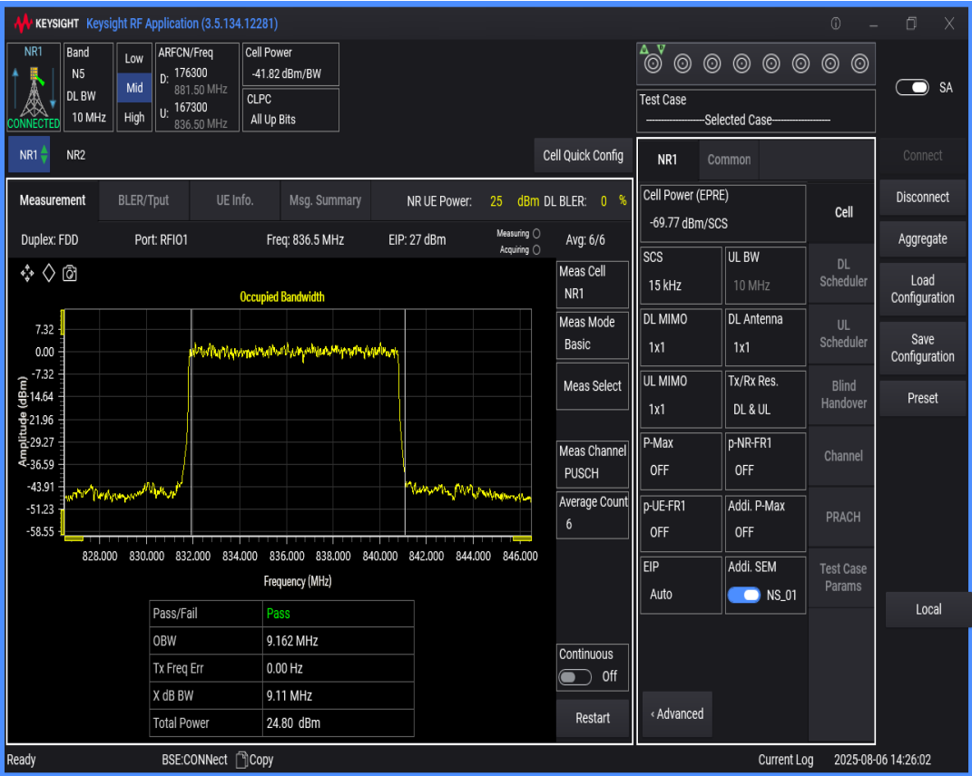
n5 SCS=15kHz DFT_BPSK BW=15MHz Channel=167300 RB=75@0
