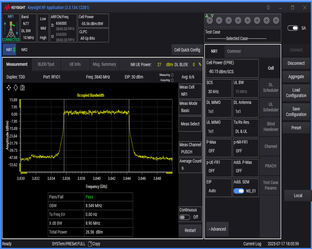
n77(3700-3980) SCS=30kHz DFT_BPSK BW=20MHz Channel=656000 RB=50@0
